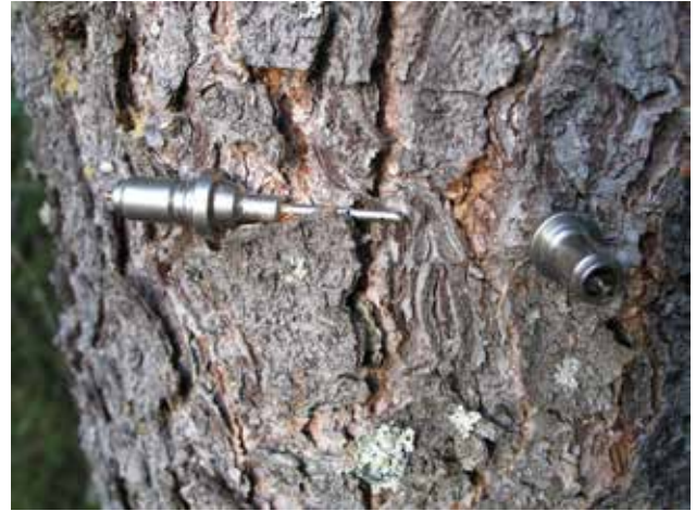
Kuva 5. Neulaventtiilillä varustettuja injektiojärkiä kuusen rungolla. Oikeanpuoleinen kärki on lyöty rungon sisään ja valmis aineen injektioon. (valokuva Risto Hagqvist)
