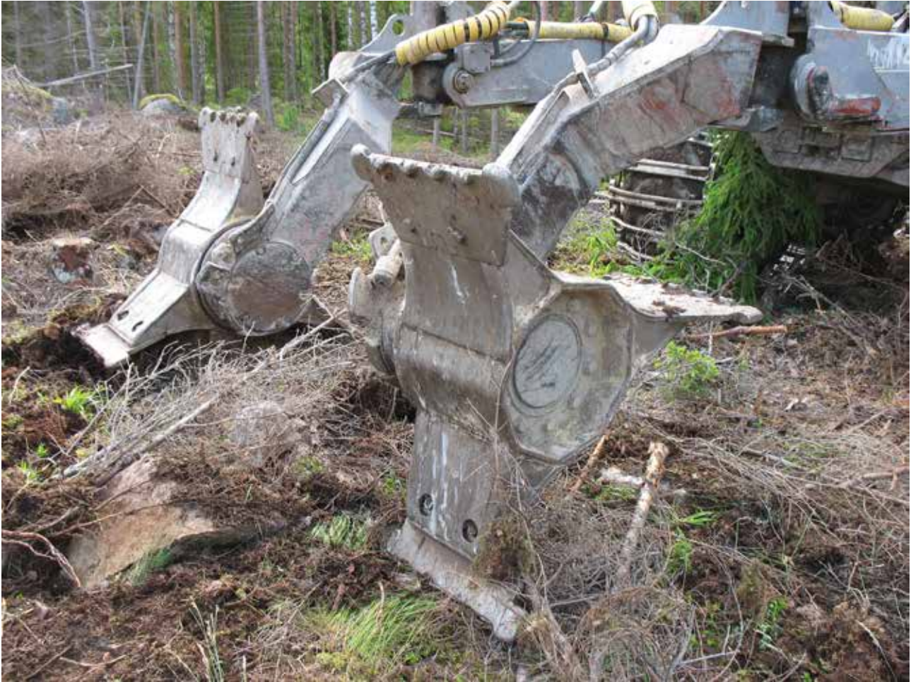
Kuva 3. Kylvömuokkausterät jatkuvatoimisen Bracke M25.a laikkurin mätäspyörissä. Terä on kiinni mätäspyörässä vain kahdella pultilla, joten se on helppo vaihtaa alkuperäisen terän tilalle. (valokuva Pekka Helenius)
