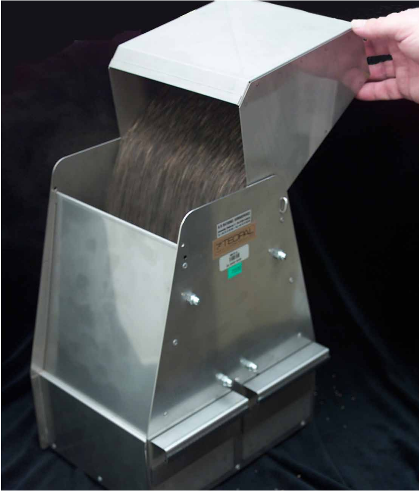
Kuva 2. Yleisjakolaite puolittaa näytteen kahteen yhtä suureen osaan, jotka vastaavat ominaisuuksiltaan (itämiskykyiset siemenet, roskat jne.) alkuperäistä näytettä. Toisen puolen puolittamista jatketaan, kunnes näyte on sopivan suuruinen (valokuva Pekka Voipio).
