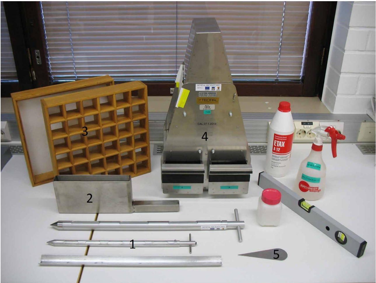
Kuva 1. Luotettavaan näytteenottoon tarvitaan erikoislaitteita, joita ei saa suoraan kaupan hyllyltä. Metlan siemenlaboratorion lokerokaira ja tyhjennyskouru kairalle (1), ”pelikaanipussi” (2) ja lokerikko (3) ovat erikseen näytteenottoa varten valmistettuja. Yleisjakolaitteita (4) on markkinoilla useita malleja. Pieniä erikoistyökaluja (5) voi muotoilla puusta tai metallista, muovin käyttöä rajoittaa staattisen sähkön muodostuminen näytteitä sekoitettaessa. Välineiden puhdistamiseen tarvitaan teollisuusalkoholia; vesivaa’alla tarkistetaan, että näytteenjakolaitte on vaakasuorassa näytettä puolitettaessa. (valokuva Pekka Helenius)
