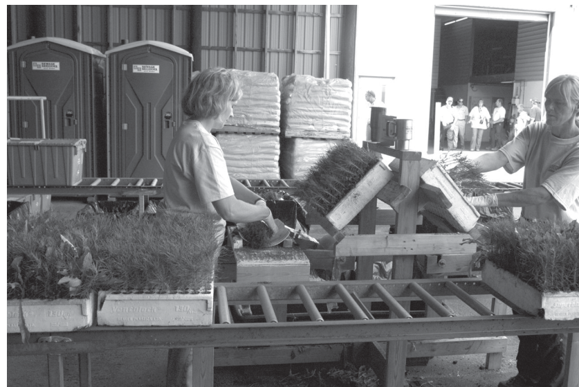
Kuva 2. Pakkauslinja Boreal nurseries -yhtiön omistamalla taimitarhalla. Styrox-arkeissa kasvatetut taimet käärittiin muovilla 20-30 taimen nipiiksi ja laadottiin joko pahviin tai muovisiin taimilaatikoihin. Kuva Ville Kankaanhuhta.
