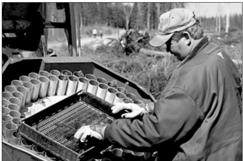
Jouni Kananen pudottaa ohjaamosta 3-4 kertaa tunnissa lataamaan taimet istutuslaitteen syöttörulettiin.
