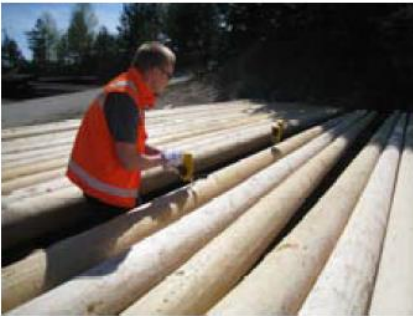
Pylväiden akustiset mittaukset ja EN 14229 standardin mukainen taivutuskoee
