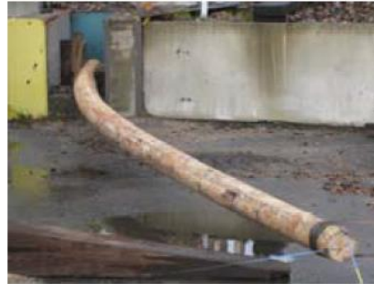
Pylväiden akustiset mittaukset ja EN 14229 standardin mukainen taivutuskoee
