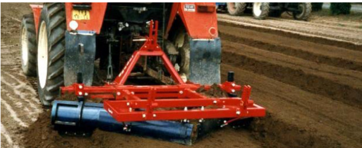
Egedal penkintekolaite tekee penkkiä muokattuun maahan. (Kuva: Egedal)
