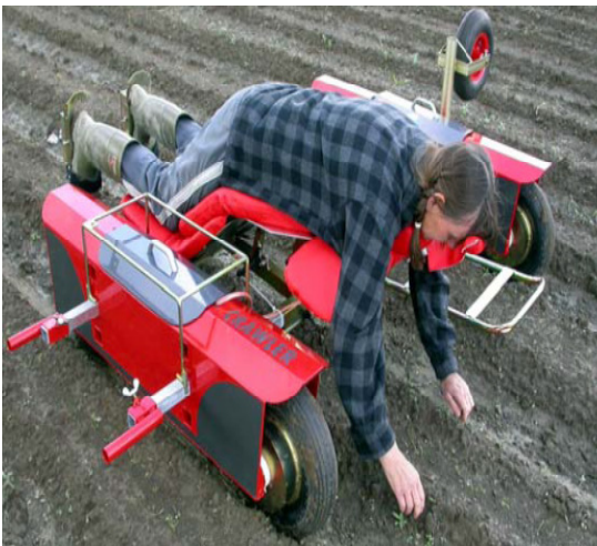
Ryömijä on akkukäyttöinen työskentelyvaunu Elomestarilta. (Kuva: Johan Ascard)
