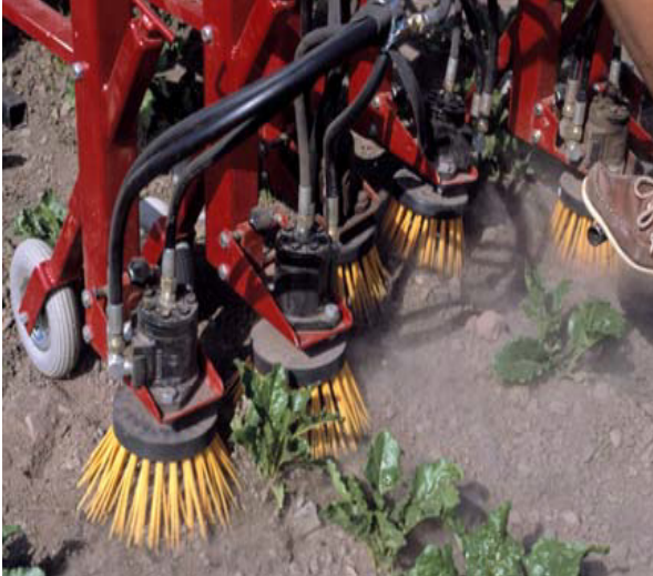
Harjaus rikkakasvitorjunnassa lähellä riviä ja rivissä. (Kuva: Johan Ascard)
