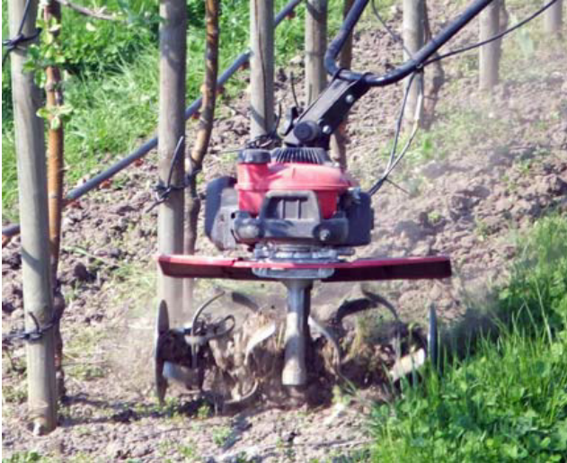
Moottorikäyttöinen hara soveltuu kovan maan suurien rikkakasvien torjuntaan. (Kuva: Sven-Axel Svensson)
