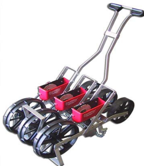
EarthWay kylvökone kolmelle riville. (Kuva: Sutton Ag)
