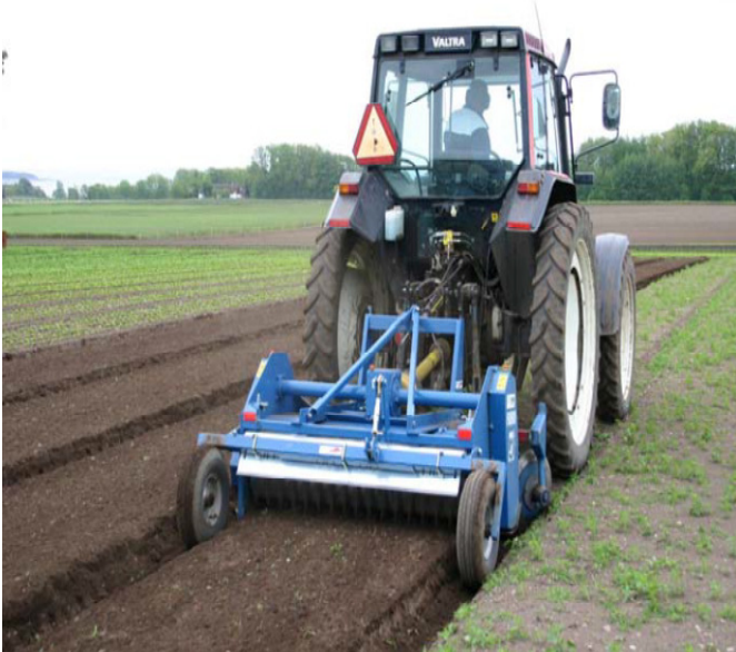
Fobro Kult Rotor 2000 jyrsii ja tekee penkin samalla ajolla. (Kuva: RJ Maskiner)
