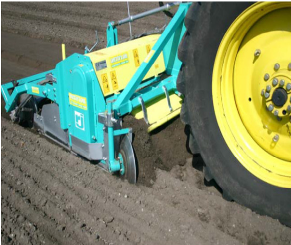
Ortiflor-Stones on sopiva penkkijärsin kivisille maille. (Kuva: RJ Maskiner)
