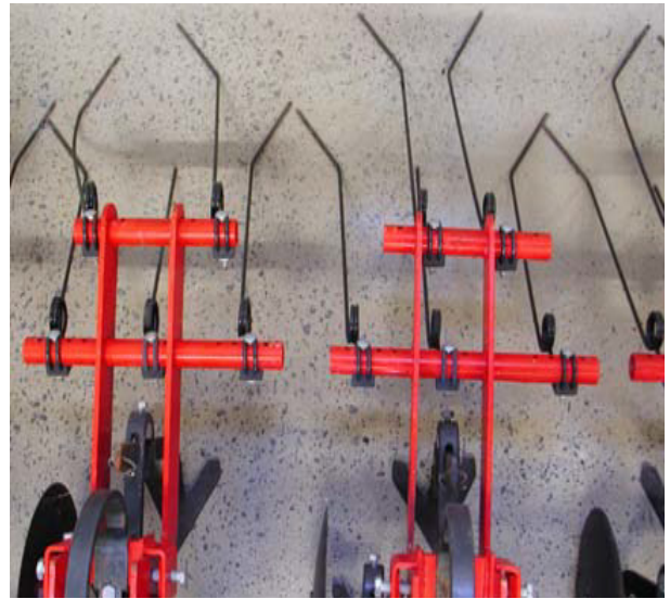
Einböck riviharan jälkiharauspara ja harauspiikit. (Kuva: Bill Alsted)
