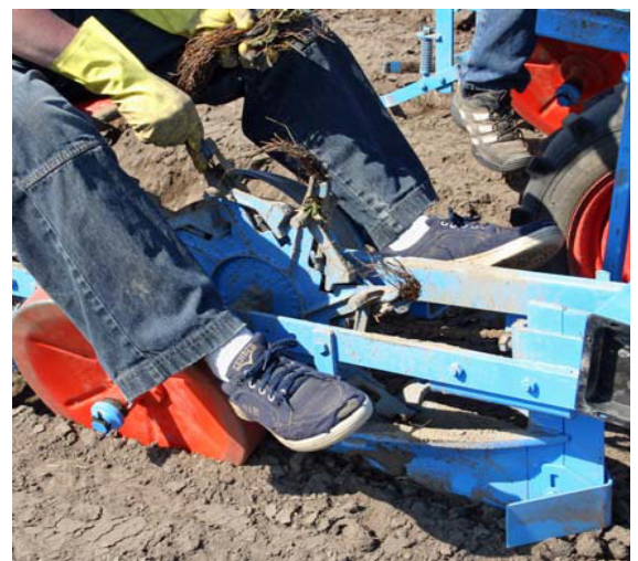
Super Prefer; voidaan istuttaa sekä paljasjuuri- että paakutaimia. (Kuva: RJ Maskiner)
