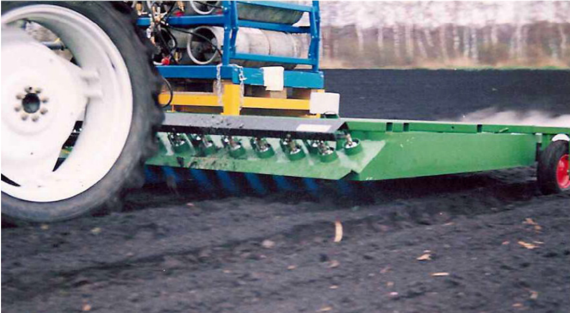
Envo-Dan soveltuu liekityslaitteeksi riviväliliekitykseen suurilla viljelmillä. Laitteen kaasunsyöttö tulee kyljellään olevista kaasupulloista. (Kuva: Bill Alsted)
