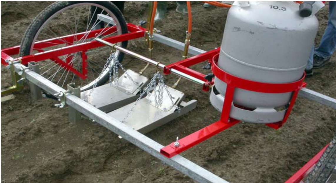
Kuvassa on Rikkamestarin työvälinealusta rivieliekkittimellä varustettuna. (Kuva: Elomestari)
