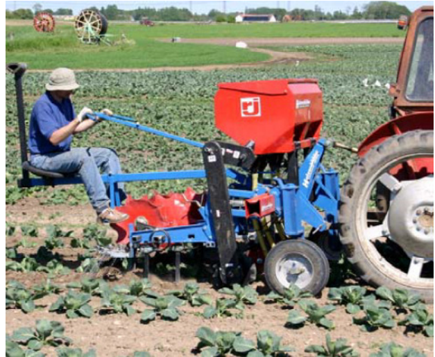
Rivihara, jossa on hanhenjalkaterät, suojavanteet, jälki-äestin ja lannoitteenlevitin. Valmistaja on Hatzenbichler. (Kuva: RJ Maskiner)
