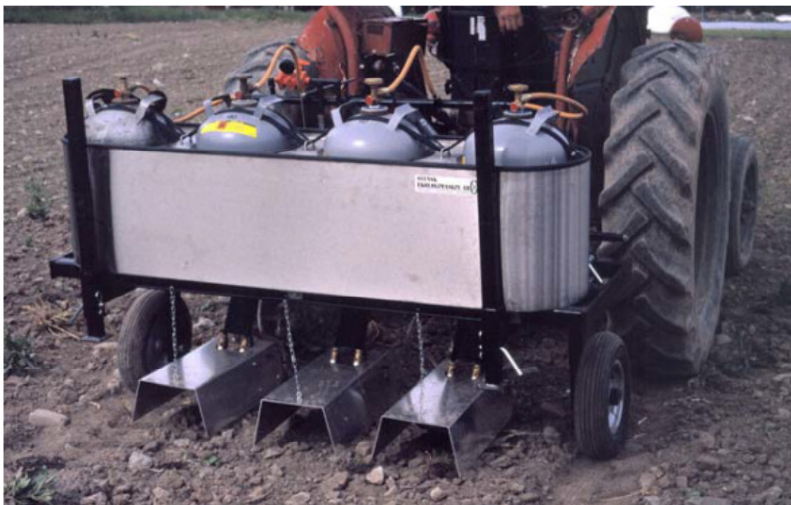
Riviliekitin, jossa kaasupullot ovat lämminvesialtaassa, jotta jään muodostus pulloissa estyy. (Kuva: Johan Ascard)
