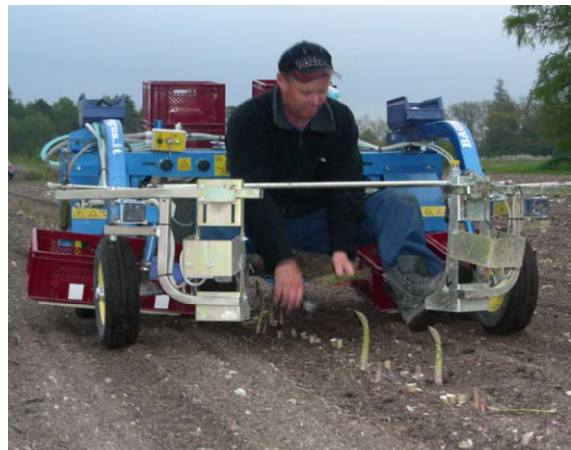
Bagioni Asp on akkukäyttöinen parsannostokone. (Kuva: Bagioni)
