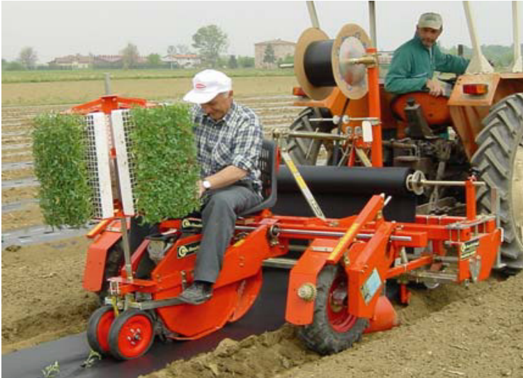
Wolf istutuskone, jossa on pyörivä syöttöteline. (Kuva: Checchi & Magli)
