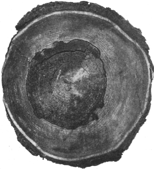
Hiililahon reuna on jotakuinkin jyrkkä, laho kuivaa ja helposti murtuvaa.
