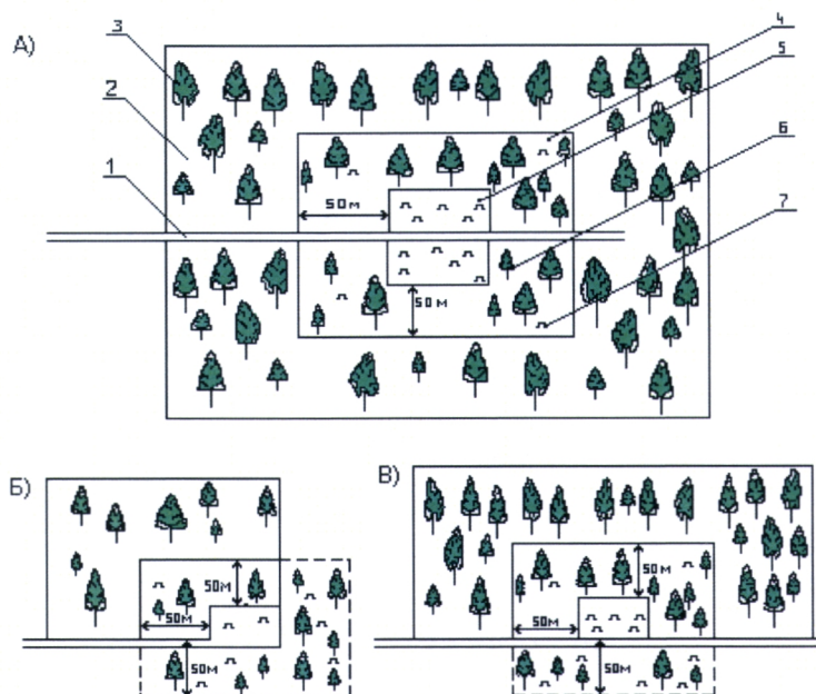
Рисунок 4.2. Схемы зон безопасности. А) площадка внутри лесосеки; Б) примыкание площадки к массиву с двух сторон; В) примыкание площадки к массиву с одной стороны; 1 – лесовозный ус; 2 – лесосека; 3 – растущее дерево; 4 – зона безопасности; 5 – лесопогрузочный пункт; 6 – подрост; 7 – пень.
