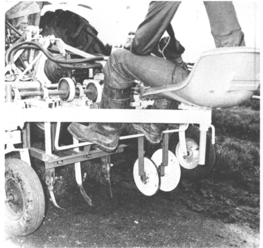
Fig. 14 "Test-bench machine" for root pruning. Kuva 14. Juurten leikkuun "koepenkkikone"
