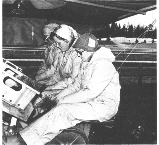
Fig. 9. Seats with back rest and a spring strap which supports the worker in a transplanting machine Kuva 9. Selkänöjälliset istuimet ja yläruumista kannattava jousitettu hibma koulintakoneessa
