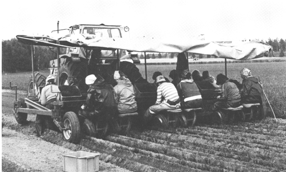
Fig. 8. A 15-unit transplanting machine at Pekolampi nursery Kuva 8. 15-paikkainen koulintakone Pekolammin taimitarhalla
