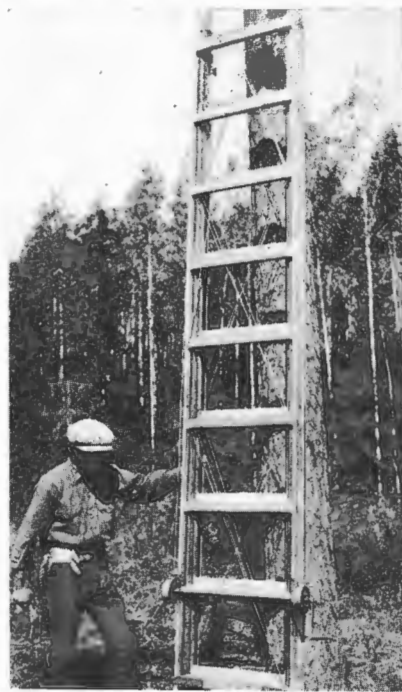
Fig. 6 and 7. — Kwat 6 ja 7 . Ladder for measuring standing sample trees. — Tikapuut pystykoepuiden mittausta varten.
