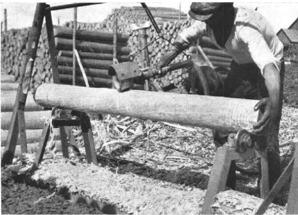
Kuva 4. Kuorimiskoneeseen yhdistetty jälkikuorintakone. Fig. 4. An instrument for after-barking, combined with the barking machine.
