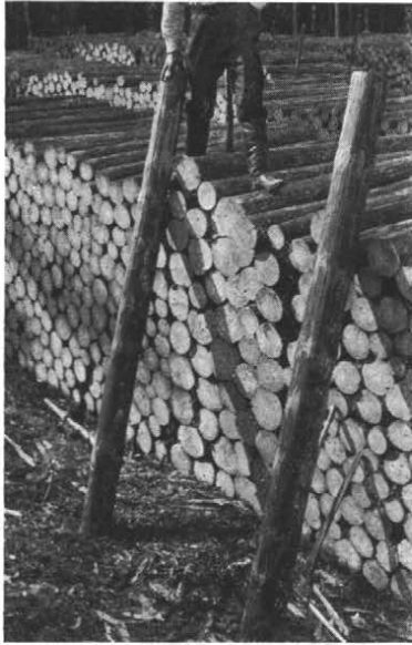
Kuva 5. 7' pituisia kaivospölkkyjä. Keskiläpimitta 14.1 cm. Kiintomitta 2.7509 k.-m 3 . Pinomitta 3.6806 p.-m 3 . Tiheys 0.7474. — Abb. 5. 7' langes Grubenholz. Mitteldurchm. 14.1 cm. Festmass 2.7509 Fm. Raummass 3.6806 Rm. Reduktionsfaktor 0.7474.
