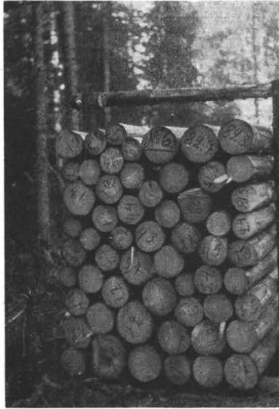
Kuva 3. 1-metrisiä puolipuhaksi kuorittuja paperipuita. Keskiläpimita 13.8 cm. Kiintomitta 0.9045 k.-m 3 . Pinomitta 1.1900 p.-m 3 . Tiheys 0.7601. — Abb. 3. 1 m langes, halbenrindetes Papierholz. Mitteldurchm. 13.8 cm. Festmass 0.9045 Fm. Raummass 1.1900 Rm. Reduktionsfaktor 0.7601.
