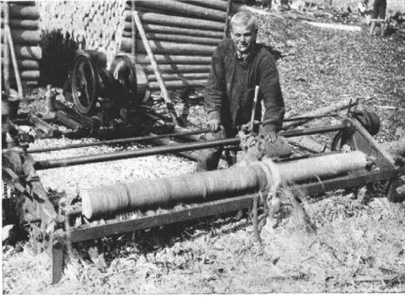
Kuva 3. Majuri R. LAGUKSEN keksimä paperipuiden kuorimiskone toiminnassa. Fig. 3. Barking machine, invented by major R. Lagus in operation.
