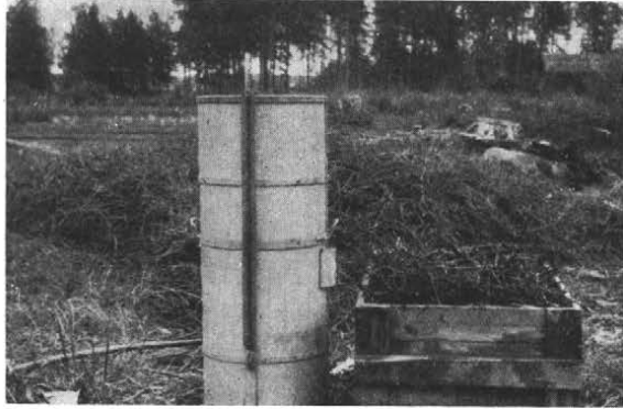
Kuva 21. Risuja. Kiintomitta 0.0365 \text{ k.-m}^3 . Pinomitta 0.4241 \text{ p.-m}^3 . Tiheys 0.0861 .— Abb. 21. Reisig. Festmass 0.0365 \text{ Fm} . Raummass 0.4241 \text{ Rm} . Reduktionsfaktor 0.0861 .
