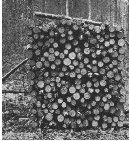
Kuva 11. 1-metrisiä pyöreitä havupuuhalkoja. Ladonta keskinkertainen. Keskiläpimitta 6.1 cm. Kiintomitta 0.7231 k-m 3 . Pinomitta 1.1639 p-m 3 . Tiheys 0.6213. — Abb. 11. 1 m lange Nadelbrennholz. Aufsetzung mitteldicht. Mitteldurchm. 6.1 cm. Festmass 0.7231 Fm. Raummass 1.1639 Rm. Reduktionsfaktor 0.6213.
