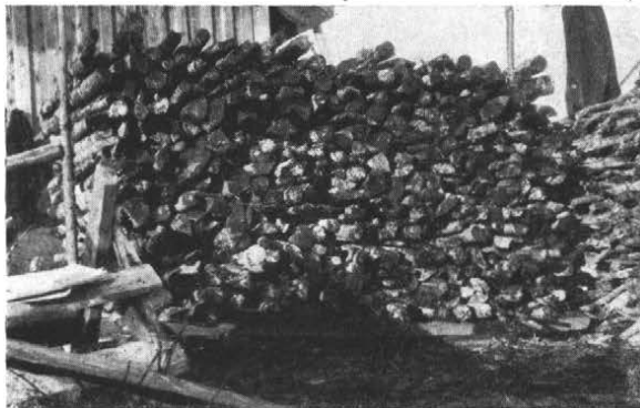
Kuva 20. 1.0—10.0 cm paksuisia ja 0.85 m pituisia havu- ja lehtipuun oksia. Kiintomitta 0.7535 k.-m 3 . Pinomitta 1.7000 p.-m 3 . Tiheys 0.4432. — Abb. 20. Nadel- u. Laubholz. Stärke 1.0—10.0 cm, Länge 0.85 m. Festmass 0.7535 Fm. Raummass 1.7000 Rm. Reduktionsfaktor 0.4432.
