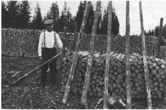
Kuva 6. 10' pituisia kaivospölkkyjä. Keskiläpimitta 8,8 cm. Kiintomitta 3,7591 k.-m 3 . Pinomitta 5,8523 p.-m 3 . Tiheys 0,6423. — Abb. 6. 10' langes Grubenholz. Mitteldurchm. 8,8 cm. Festmass 3,7591 Fm. Raummass 5,8523 Rm. Reduktionsfaktor 0,6423.
