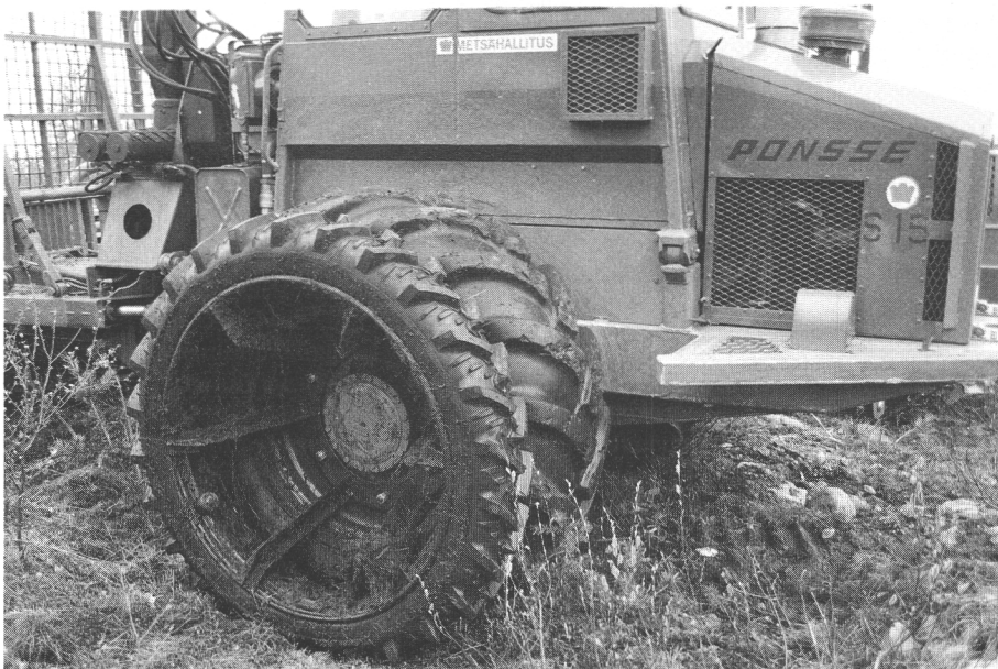
Kuva 7. Metsätraktorin etupyöriin asennetut levikepyörät (Kuva: T. Heikka).
