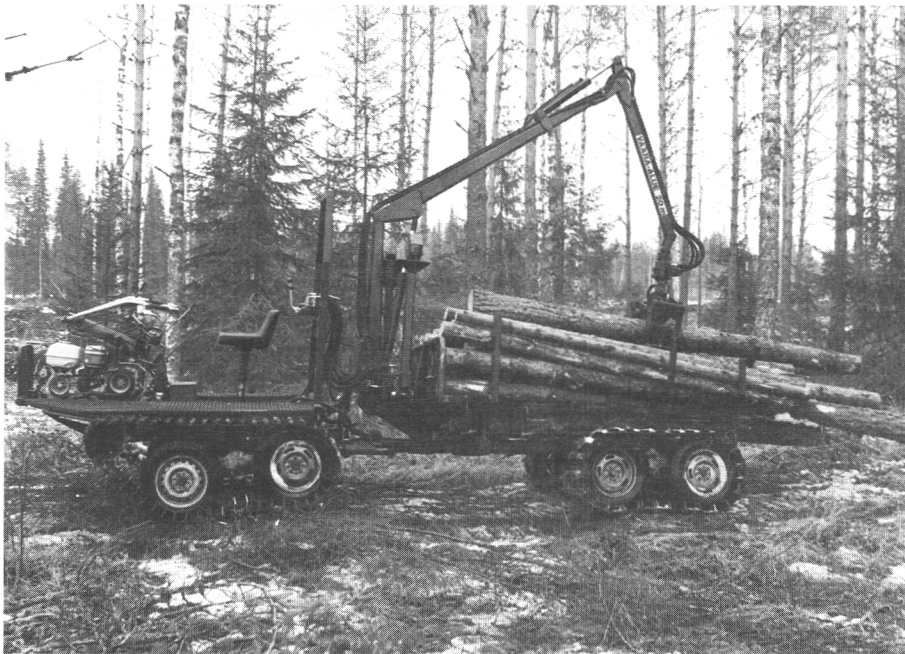
Kuva 9. Puutarhatraktorista kehitetty maastoajoneuvon prototyyppi (Kuva: S. Takalo). Figure 9. Prototype forwarder based on garden tractor (Photo: S. Takalo).
