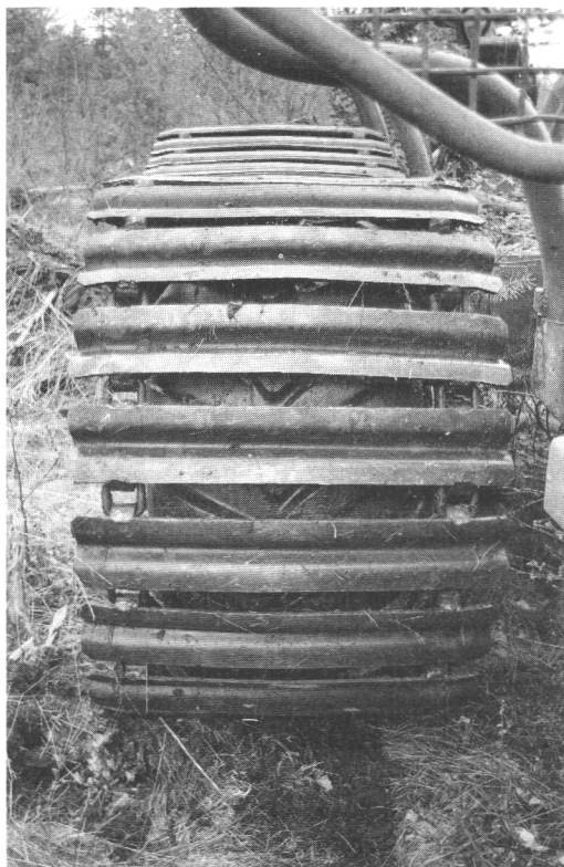
Kuva 8. Metsätraktorin erikoisleveät takatelat (Kuva: T. Heikka). Figure 8. High flotation tracks for forwarder bogie (Photo: T. Heikka).
