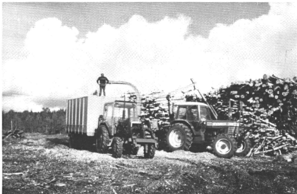
Kuva 14. TT 1000 TU on johtava hakkurimalli Suomen lämpölaitosten hakkeen hankinnassa. Fig. 14. The TT 1000 TU is the leading chipper mark in procurement of chips to Finnish heating plants.
