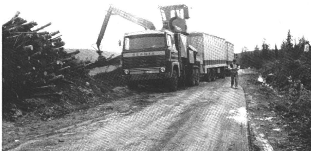
Kuva 15. TT 1500 LP -laikkahakkuri metsäteollisuuden raaka-aineeksi tarkoitetun hakkeen valmistukseen. Fig. 15. The TT 1500 LP disc chipper for conversion of chips to raw material for the forest industry.
