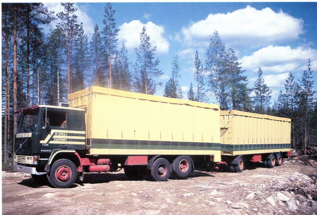
Kuva 1. Hake pyritään kuljettamaan täysperävaunullisilla kuorma-autoilla etenkin pitkiltä etäisyyksiltä. Auton kuormatilavuus on 101 m 3 irtotilavuutta. (Kuva H. Kalaja).
