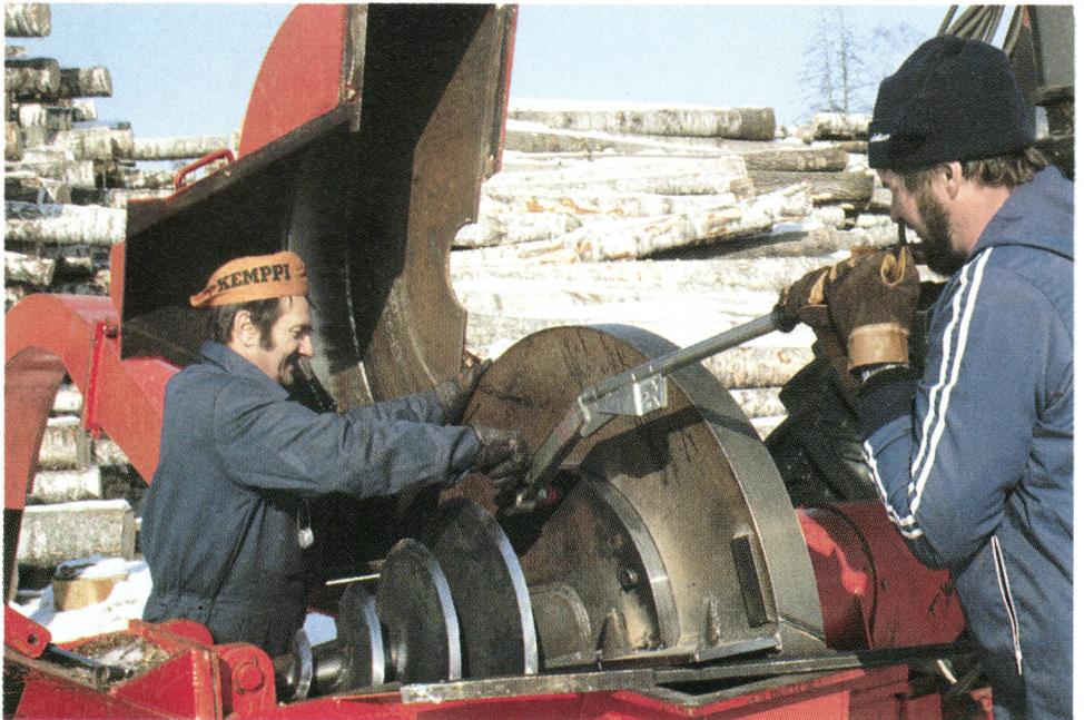
Fig. 2. Mounting an L-size knife. Kuva 2. L-terän kiinnitys käynnissä.
