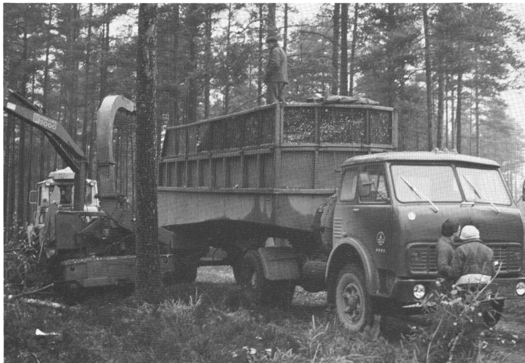
Рис. 4. Производство щепы у лесной дороги. Kuva 4. Haketusta metsätien varressa. Fig. 4. Whole-tree chipping at the landing.
