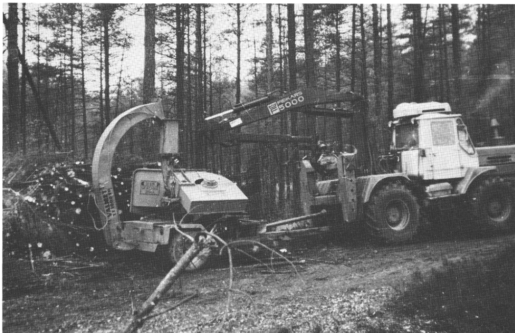
Рис. 3. Комплект оборудования для производства зеленой щепы из тонкомера у автодороги. Kuva 3. Haketuksessa käytetty kalusto metsätien varressa. Fig. 3. Equipment used in chipping alongside the forest road.
