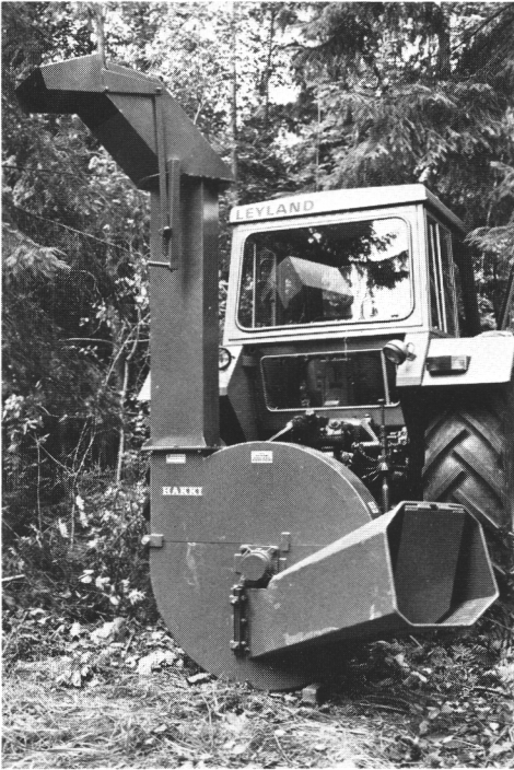
Kuva 5. Käsisyöttöinen laikkahakkuri (HAKKI H-200). Fig. 5. Manually fed disc chipper (HAKKI H-200).
