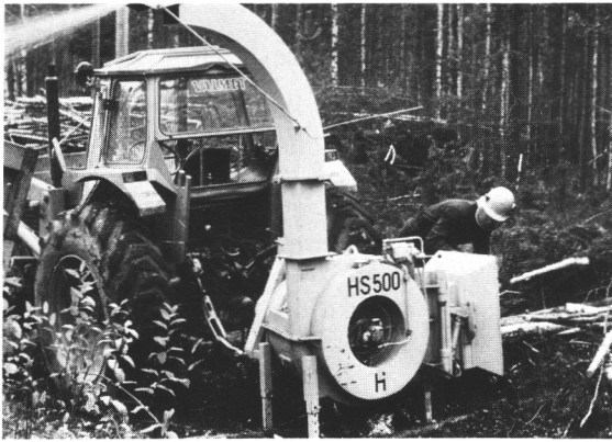
Kuva 9. Hydraulisyöttöinen rumpuhakkuri (HS-500 HD). Fig 9. Hydraulically fed drum chipper (HS-500 HD).
