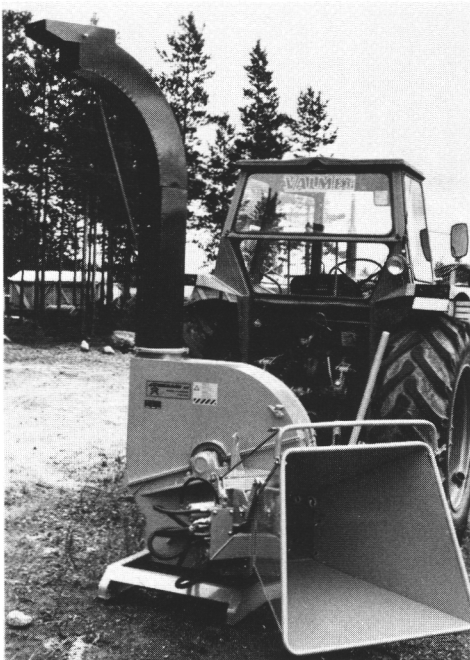
Kuva 6. Hydraulisyöttöinen laikkahakkuri (JUNKKARI HJ6+SL6). Fig. 6. Hydraulically fed disc chipper (JUNKKARI HJ6+SL6).
