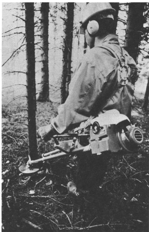
Kuva 5. Raket RS 601 -raivaussaha. (Kuva Oy Elfving Ab) Fig 5. Raket RS 601 clearing saw. (Photo Oy Elfving Ab)
