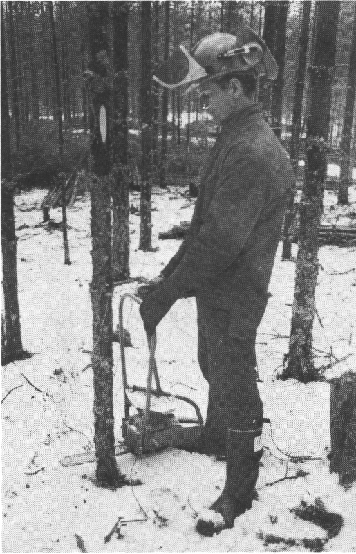
Kuva 13. Puitten siirtely-kaato M/Jaaranen-Rantapuu kahvoilla varustetulla moottorisahalla. Vertailuaineisto.
