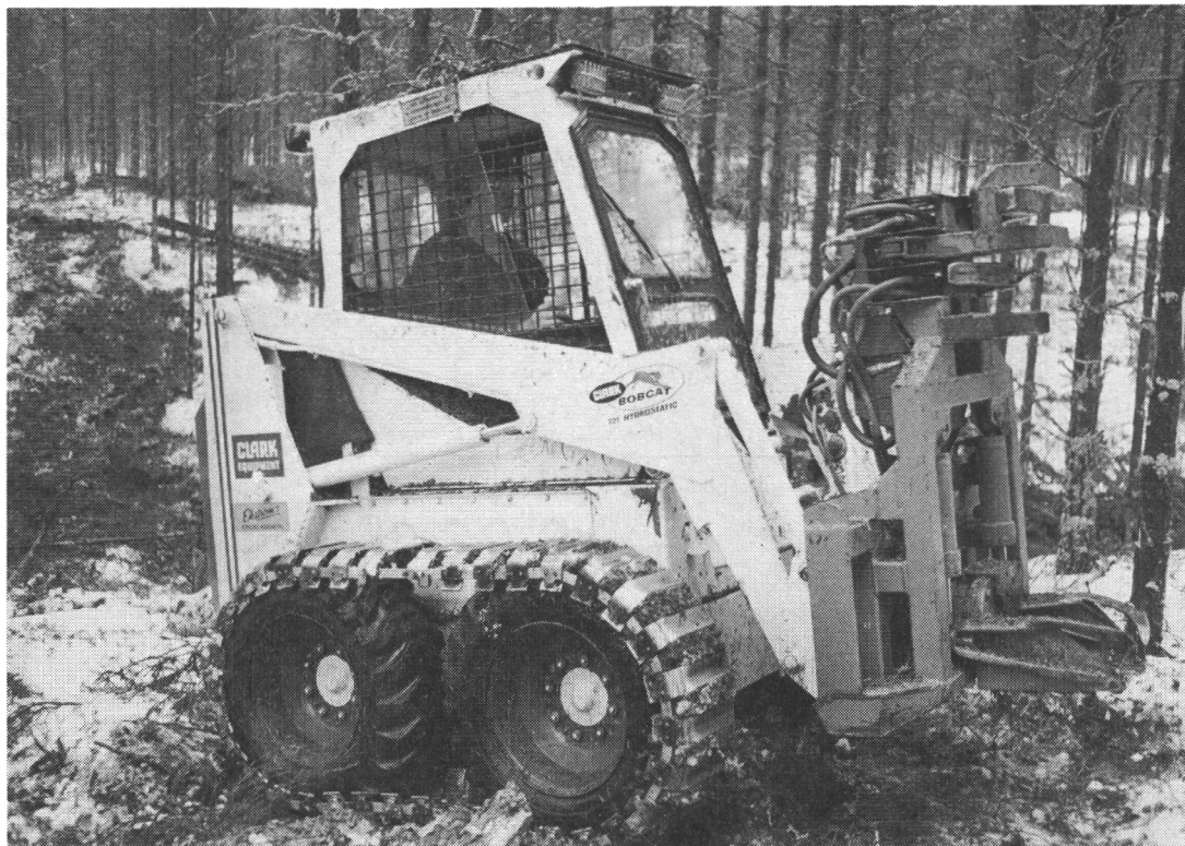
Kuva 2. Kaato-kasauslaite Bobcat M-721 kuormaajaan kiinnitettynä. Peruskone teloilla varustettuna. Figure 2. The felling-bunching device mounted on the Bobcat M-721 loader. The basic machine is equipped with tracks.
