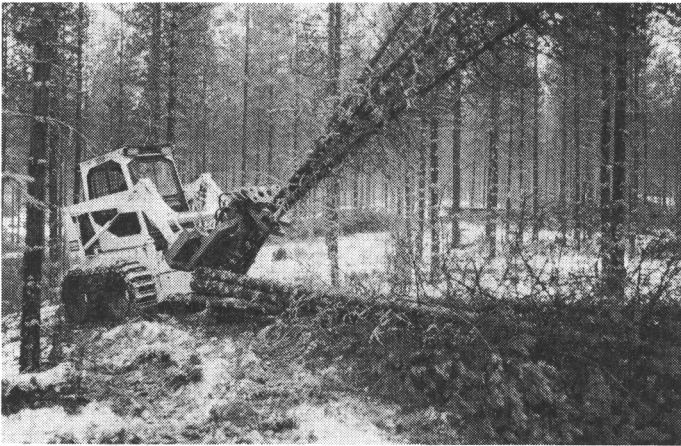
Kuva 6. Taakan pudottaminen ajouran varteen. Figure 6. Unloading the trees alongside a strip road.
