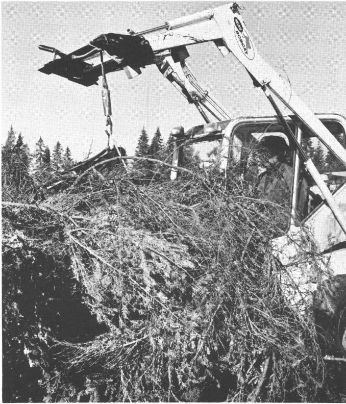
Kuva 3. Oksaraaka-aineen punnitseminen kuormaajan haarukkakouran tukivarsille ripustetulla dynamometrillä.
