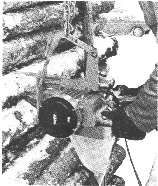
Kuva 2. Näytteenotto norjalaisella jyrsimellä. Fig. 2. Sampling with the Norwegian chain sampler.
