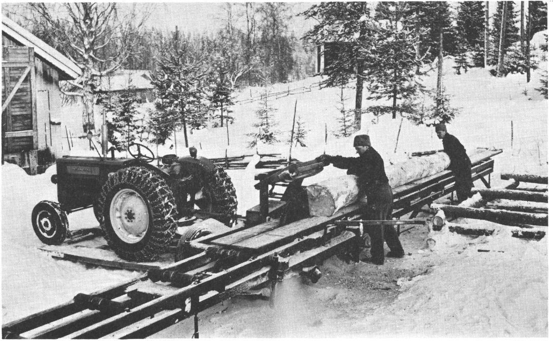
Kenttäsiirkeli toiminnassa. Kuvallaina SOK:lta. — A field-saw: the commonest sawmills not covered by the Industrial Statistics.
