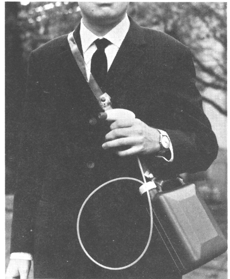
Kuva 7. Taskutuksessa ja kantokäsittelyssä yleiseen käyttöön päässyt vesapistooli. Kuvassa malli "Maxi", jonka nestesäiliön tilavuus on 2,5 l. Pienemmässä "Minissä" säiliön mahtuu 0,6 l.
