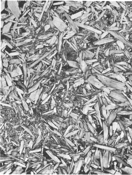
Kuva 1. Erilaisista vaneritehtaan puujätteistä valmistettua haketta
