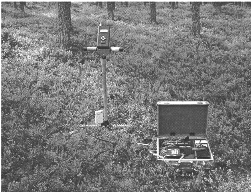
Kuva 1. CS615 –anturi (Campbell Scientific Ltd. UK), KD10 –ohjain (Campbell Scientific Ltd. UK) ja ominaisvastustalikko (Geologian tutkimuskeskus, Suomi).
