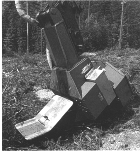
Kuva 3. Bräcke-istutuslaite, vasemmalta mätästyslevy, runko ja taimipöydän suojalaatikko.
