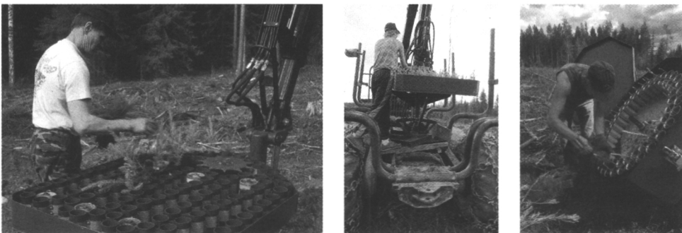
Kuva 16. Vasemmalla maataloustraktorin Ilves-istutuslaitteen taimipöydän täytössä työskentelykorkeus on hyvä, mutta taimivarasto on korkealla traktorin katolla. Keskellä metsätraktorin kuormatila on hyvä paikka taimien kuljetukseen, mutta taimipöydän täyttö kuormatilassa on vaarallista liukastumis- ja putoamisvaaran takia. Oikealla Bräcken taimipöytä on vinosti maassa, jolloin työn tekijä joutuu alimpia holkkeja täyttäessään kumartumaan selkään kiertyneessä asennossa. Taimien kuljetusvarasto on hyvällä korkeudella kaivinkoneen takana.
