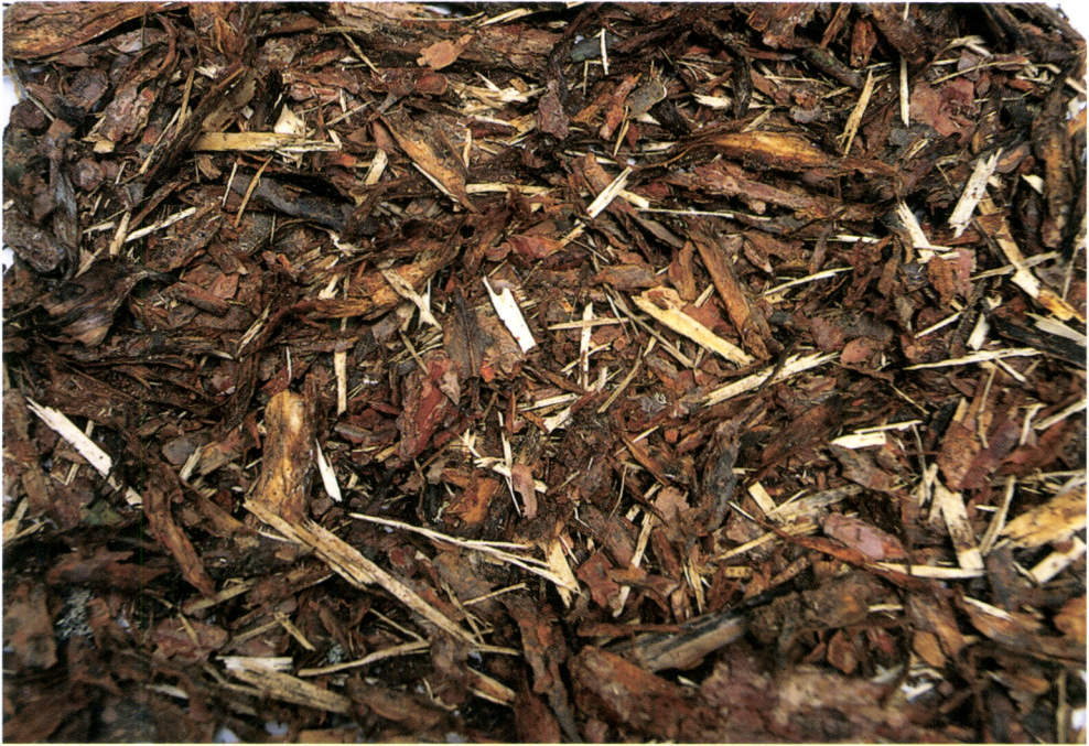
Kuva 8. Piiskaus- ja rummutuskäsittelyssä prosessitähteen sekaan joutuu myös runkokuuta, mutta kuorintahävikin osuus jää kuitenkin yleensä alle 2 %:n (kuva Hannu Kalaja).
