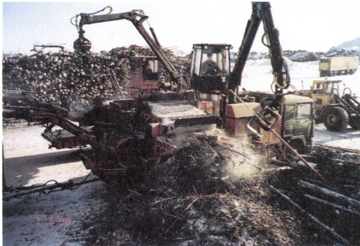
Kuva 3. Hooli Oy:n kuorma-auton alustalle rakentama ketjukarsijakuorijan, prosessitähteen murskaimen ja hakkurin yhdistelmä käsittelemässä osapuuna korjattua pieniläpimittaista mäntykuitupuuta tehdasterminalissa Kemissä (kuva Ari Hooli).
