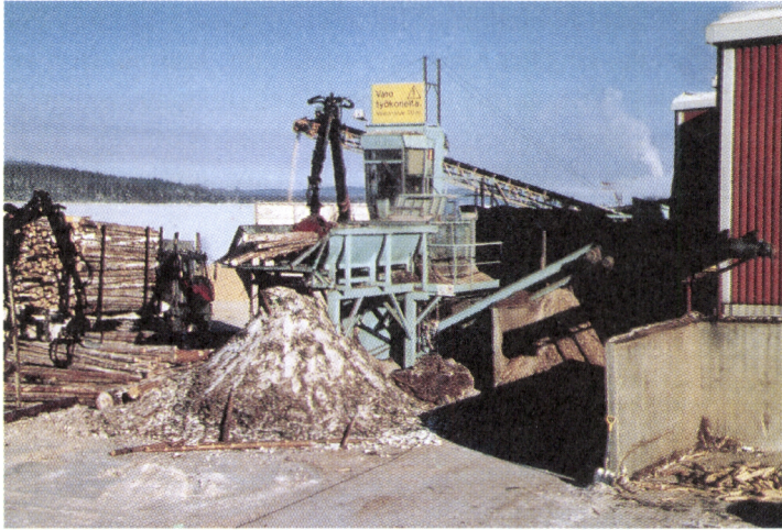
Kuva 2. Pertti Szepaniak Oy:n ketjukarsijakuorijasta, pienrummusta, hakkurista ja hakeseulasta koostuva ensiharvennuspuun käsittelyasema Enso Oy:n Kaukopään tehdasvarastolla Imatralla (kuva Hannu Kalaja).
