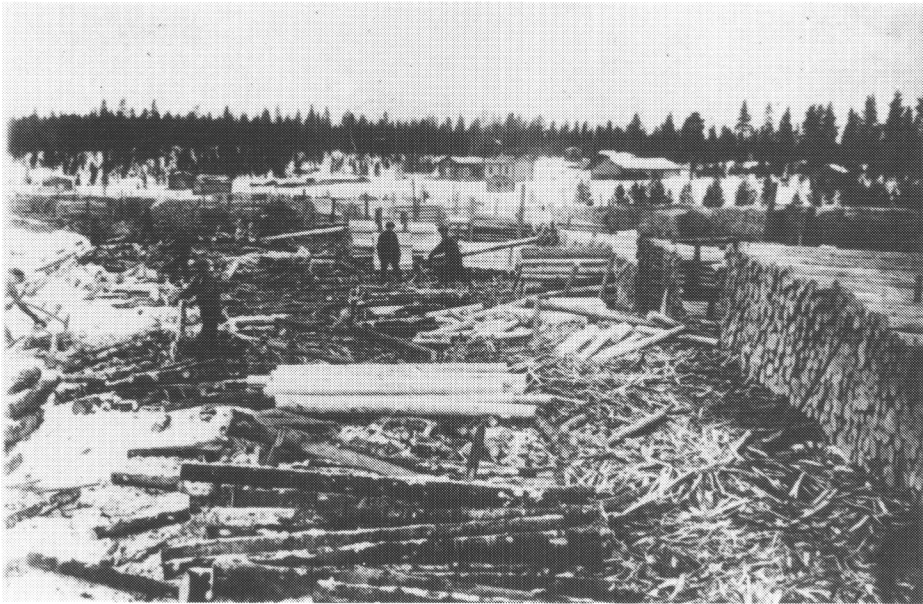
Kuva 17. Majovan parkkuulanssi Siuruanjokivarressa v. 1929. Oli talouselämän syvä lama. Puolipuhtaalle kaksimetriselle kuusipaperipuulle ei ollut tuona vuonna menekkiä. Siksi se vuoltiin täyspuhtaaksi ja katkaistiin metriseksi, joka kävi kaupaksi. Etualalla kuoripäällistä ja kuorittua tukkia. Kuva Eino Pohjola.
