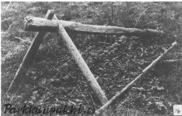
Kuva 14. Palstalla käytetty kuorimapukki eli jänis. Vieressä kahden metrin mittainen lovipäinen mittakeppi. Kuva Eino Pohjola.
