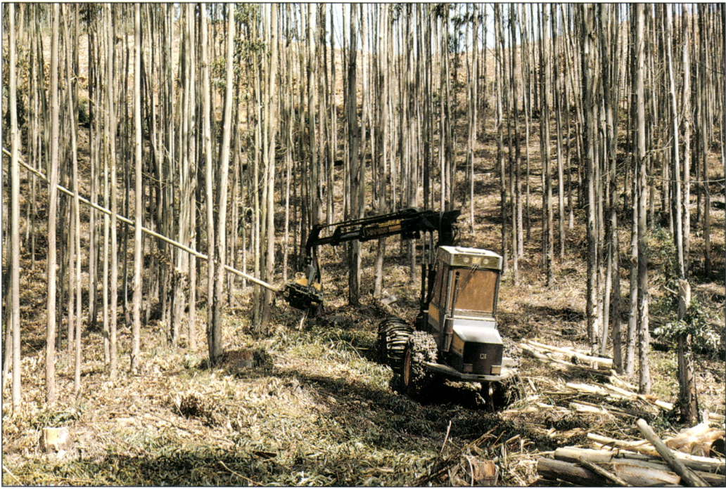
Kuva 16. Ponsse HS15 hakkukone eukalyptusmetsikön päätehakuussa. Rungon keskikoko 0,2 m 3 . Figura 16. La cosechadora forestal Ponsse HS15 operando en corta a tala rasa en rodales de eucalipto. El tamaño promedio de la troza es de 0,2 m 3 .
