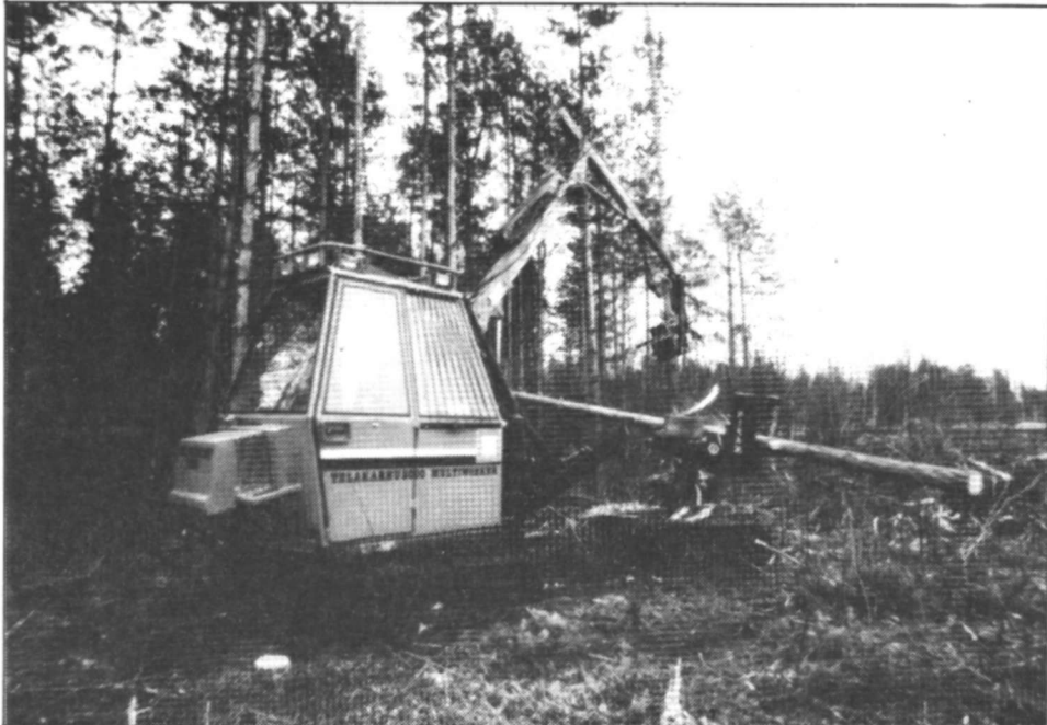
Kuva 1. Telakarhu 2000 varustettuna Pika 36 -prosessorilla ja Pika 37 -kaatopäällä.
