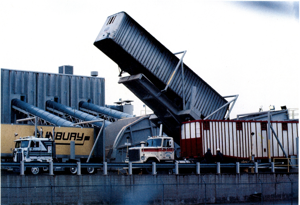
Kuva 40. Hakeautot tyhjennetään kiinteillä kippauslaitteilla.
