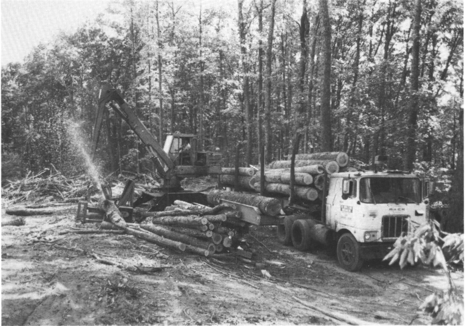
Kuva 27. CTR -katkontakone, Barko-kuormain ja Mack -puutavara-auto kuormauspaikalla.
