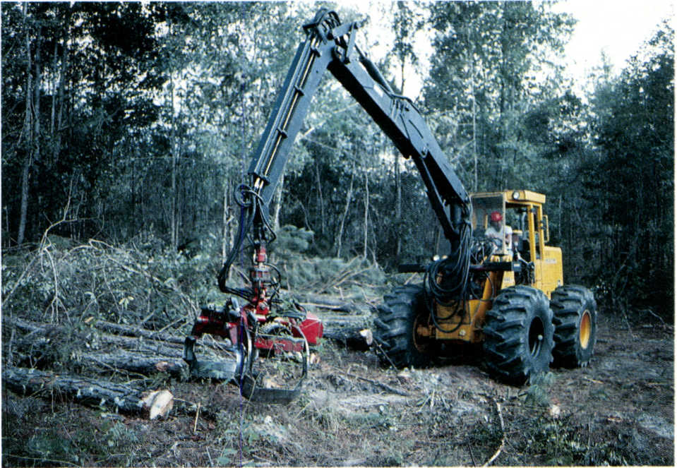
Kuva 23. John Deere 444 -alustainen Valmet 940 GP -kuormainprosessori.
