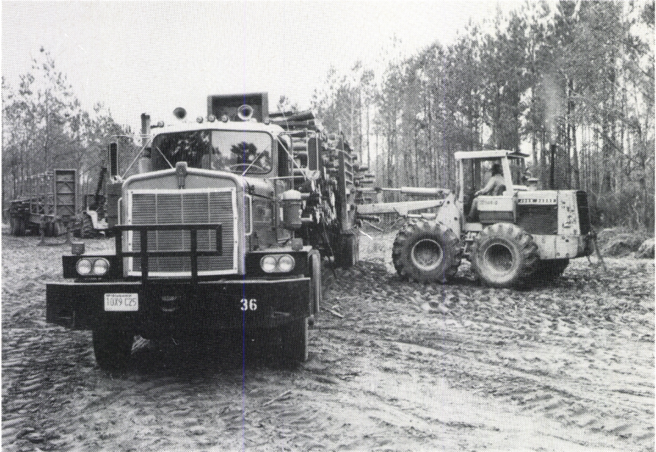
Kuva 35. Puskulevyllä varustettua traktoria käytetään kuorman sivujen tasauksessa.
