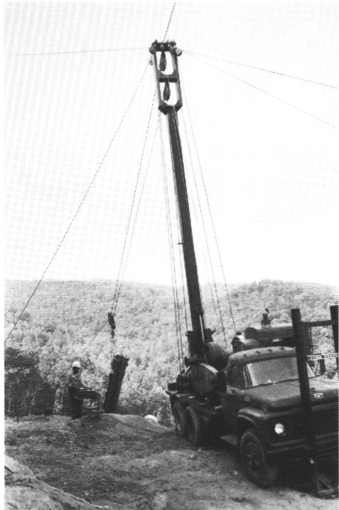
Kuva 34. Maanrakennustöissä käytetystä vintturista rakennettu kuorma-autoalustainen vaijerijuontolaite Appalakkien vuoristossa.
