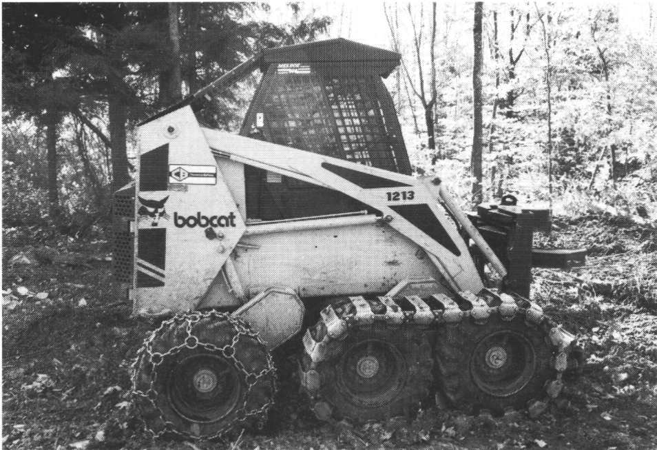
Kuva 16. Bobcat -pienetraktori kaatokoneena.
