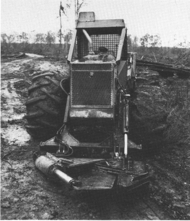
Kuva 15. Kaatoterällä varustettu Timberjack 450 A -laahusjuontotraktori.
