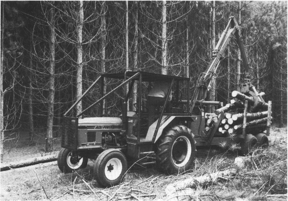
Kuva 46. Agri-Power -maataloustraktori ja Hawk -metsäperävaunu kuormaimineen.
