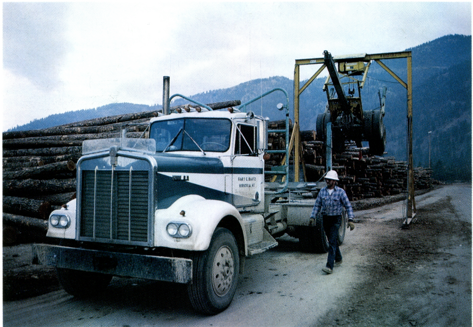
Kuva 37. Runkojen kuljetukseen suunnitelluissa puutavara-autoissa takateli aisoineen nostetaan veto-vaunun päälle tyhjänäajon ajaksi.
