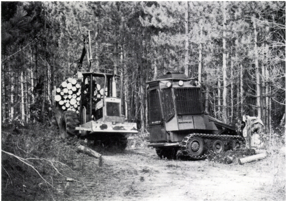
Kuva 42. Makeri 33T -harvesteri ja Iron Mule 5050 -kuormatraktori punamäntyviljelmän harvennuksessa Järvialueella.
