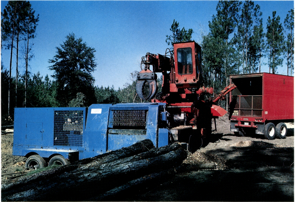
Kuva 36. Morbark 22 -hakkuri ja kokeilukäytössä oleva ketjukuorimakone.
