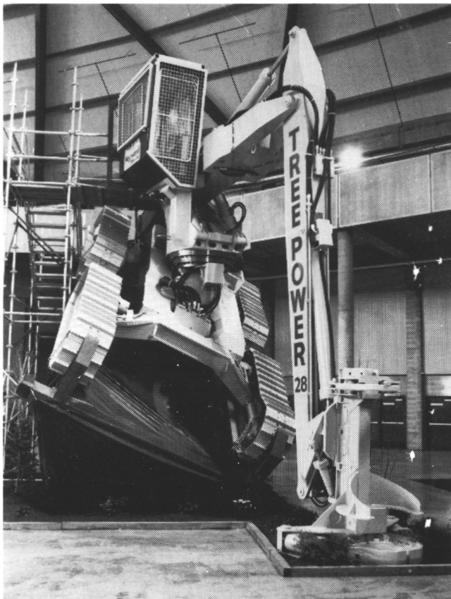
Kuva 20. Vuoristometsiin tarkoitettu Tree Power -kaatokone.
