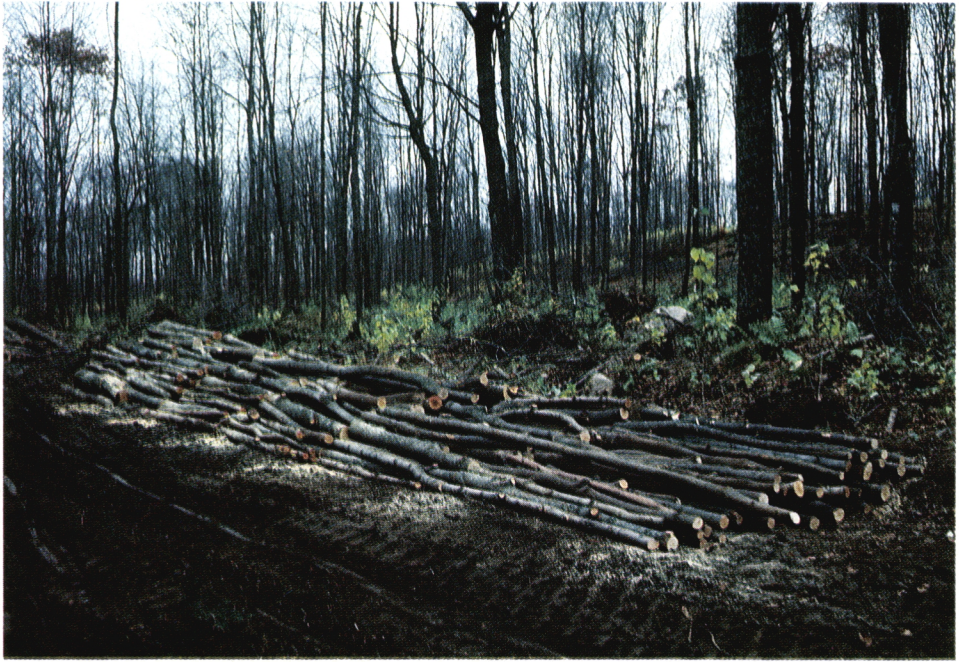
Kuva 43. Kokonaisina juonnettujen runkojen moottorisahakatkonta välivarastolla vaatii paljon tilaa.
