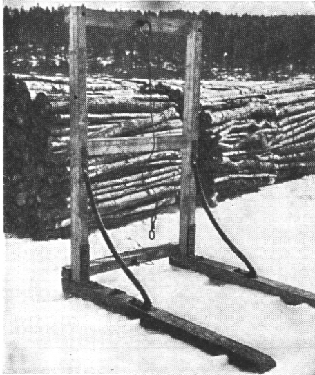
Rannalta jälle hevosella ajettu pinotavara ladotaan niputuskehiin. Metsästä ajettaessa puut ladotaan tavallisesti ensin pinoon.
