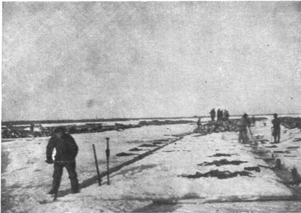
Merinippujen teko on myös eräs talviniputuksen muoto. Jäähän sahataan suuri avanto, kettingit asetetaan sen yli ja lopuksi autolla tai muuten jäälle tuodut tukit siirretään avannon kohdalle. Nipun suuruus jopa 10.000 j 3 .
