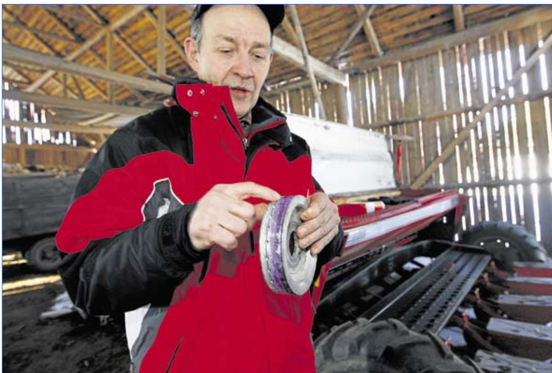
Sokerijuurikkaan kylvökone taipui rapsin kylvöön, kun syöttöpyörän kolot täytettiin autojen korjausmassalla, Seppo Hunsu näyttää.
