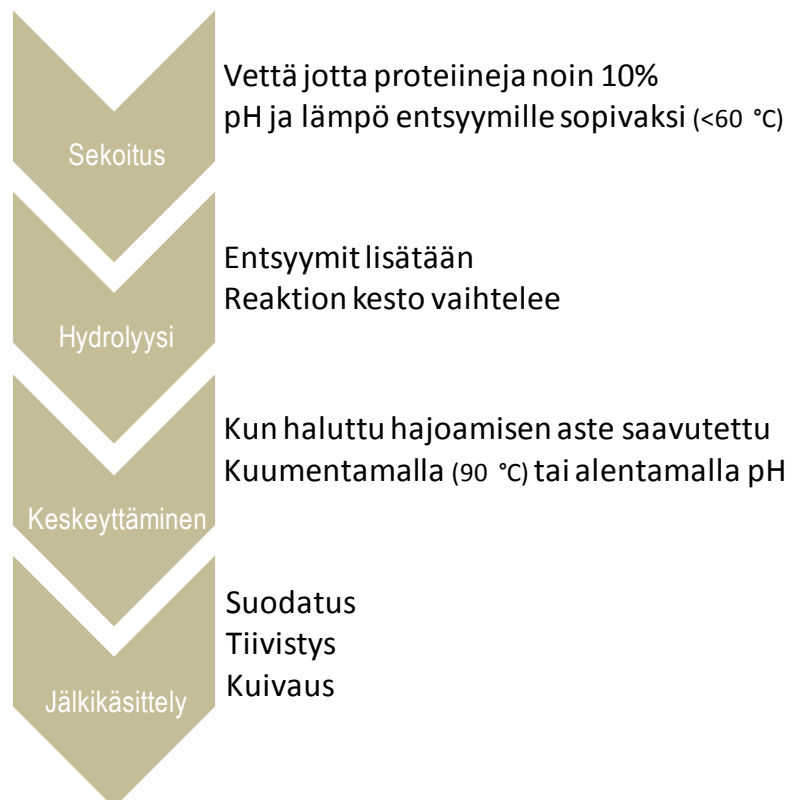
Kuva 14. Proteiini-isolaatin valmistaminen entsyymaattisesti (Thorkelsson ja Kristilsson 2009).
