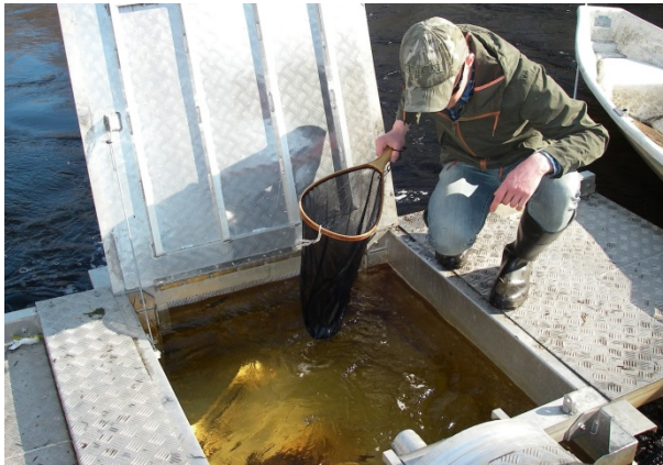
Kuva 1. a) Muuramenjoen ruuvi sijaitsi Alakosken alaosalla uoman poikkileikkauksen syvimmissä kohdassa, jossa myös virrannopeus oli suurin. b) Läsäkosken ruuvi asennusvaiheessa Alakosken alaosalla lähellä jokisuuta kovimmassa virrassa. c) Ruuvipyödysten kalakammio tyhjennettiin haavilla. d) Ruuvipyödysten pyydystämät taimenet olivat väriltään hopeisia. Kuvan kala on merkitty ankkurimerkillä.
