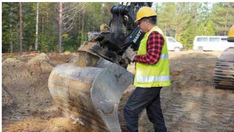
Рис. 35. При проведении технического обслуживания машины рабочий орган должен находиться на земле в устойчивом положении.
