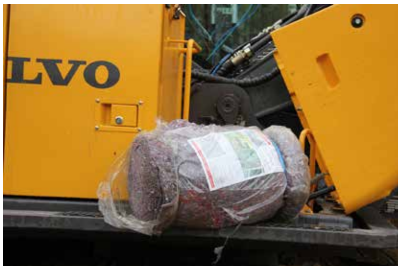
Рис. 36. Впитывающий текстиль для очистки почвы от нефтепродуктов должен быть включен в комплект машиниста.
