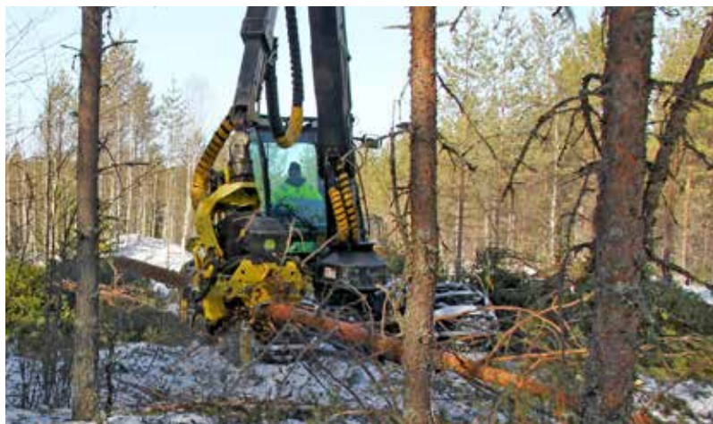
Рис. 3. На устойчивых к нагрузкам грунтах деревья валят по схеме «валка вперед». Порубочные остатки оставляют в кучах для удобства погрузки и вывозки их с делянки.
