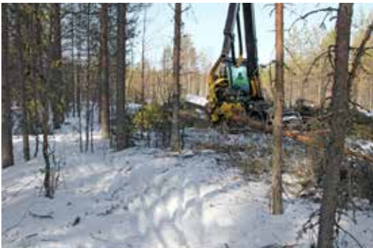
Kuva 3. Kantavilla maastokohteilla puut kaadetaan eteenpäin. Hakkuutähteet tulevat kasamuodostelmiin, joista niiden kuljetus onnistuu kuormatraktorilla.
