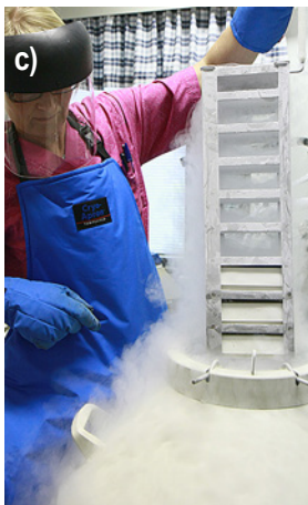
Kuva 5.7. a) Kuusen epäkypsiä siemenalkioita kasvatusalustalla. Kuva Lassi Palmujoki. b) Siemenalkiosta kasvamaan lähtenyt alkiontuottokykyistä solukkoa. Kuva Saila Varis. c) Solukkonäytteet säilötään -196 asteiseen nesteeseen useiksi vuosiksi. Kuva Tuija Aronen.
