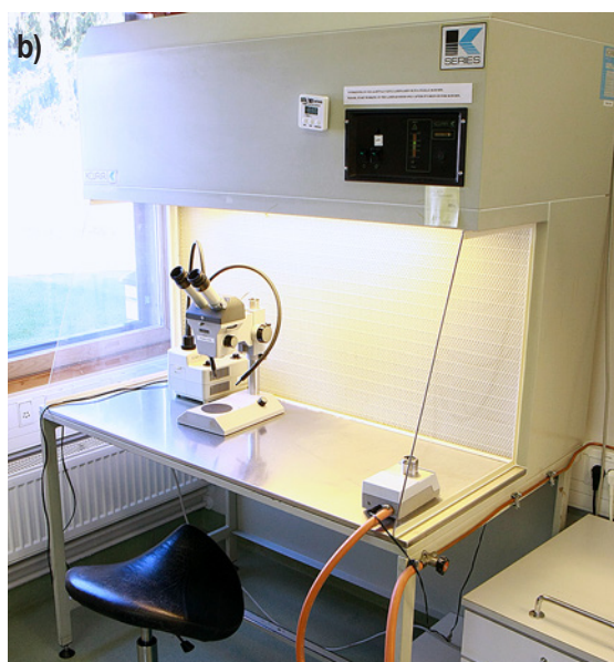
Kuvat 4.4. Vaakavirtauslaminaareja ja kaasuletkun päässä olevat bunsenliekittimet. a) Kahden hengen laminaarissa myös pöytätasoon kiinnitettävä luuppilamppu, b) yhden hengen laminaarissa stereomikroskooppi. Kuvat Lassi Palmujoki.
