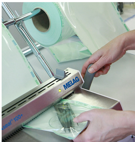
Kuva 4.3. Pientarvikkeet autoklavoidaan kuumentamalla suljettavissa pusseissa. Kuva Lassi Palmujoki.
