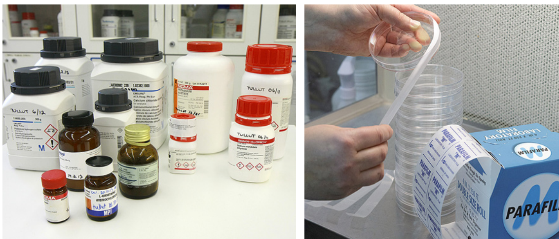
Kuva 4.10. a) Eri valmistajien ja maahantuojien kemikaaleja. Kuva Lassi Palmujoki. b) Parafilmiä käytetään petrimaljojen sulkemiseen. Kuva Timo Kilpeläinen
