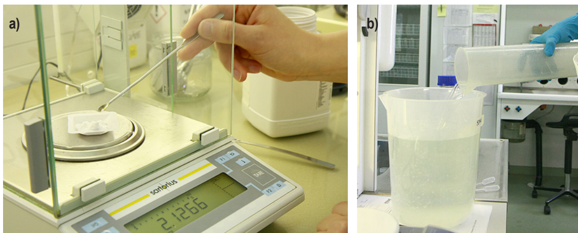
Kuva 5.3. a) Osa alustan ainesosista on jauheita ja ne punnitaan analyysivaa'alla. b) Kun kaikki ainesosat on lisätty, täytetään astia haluttuun tilavuuteen vedellä. Kuvat Lassi Palmujoki.
