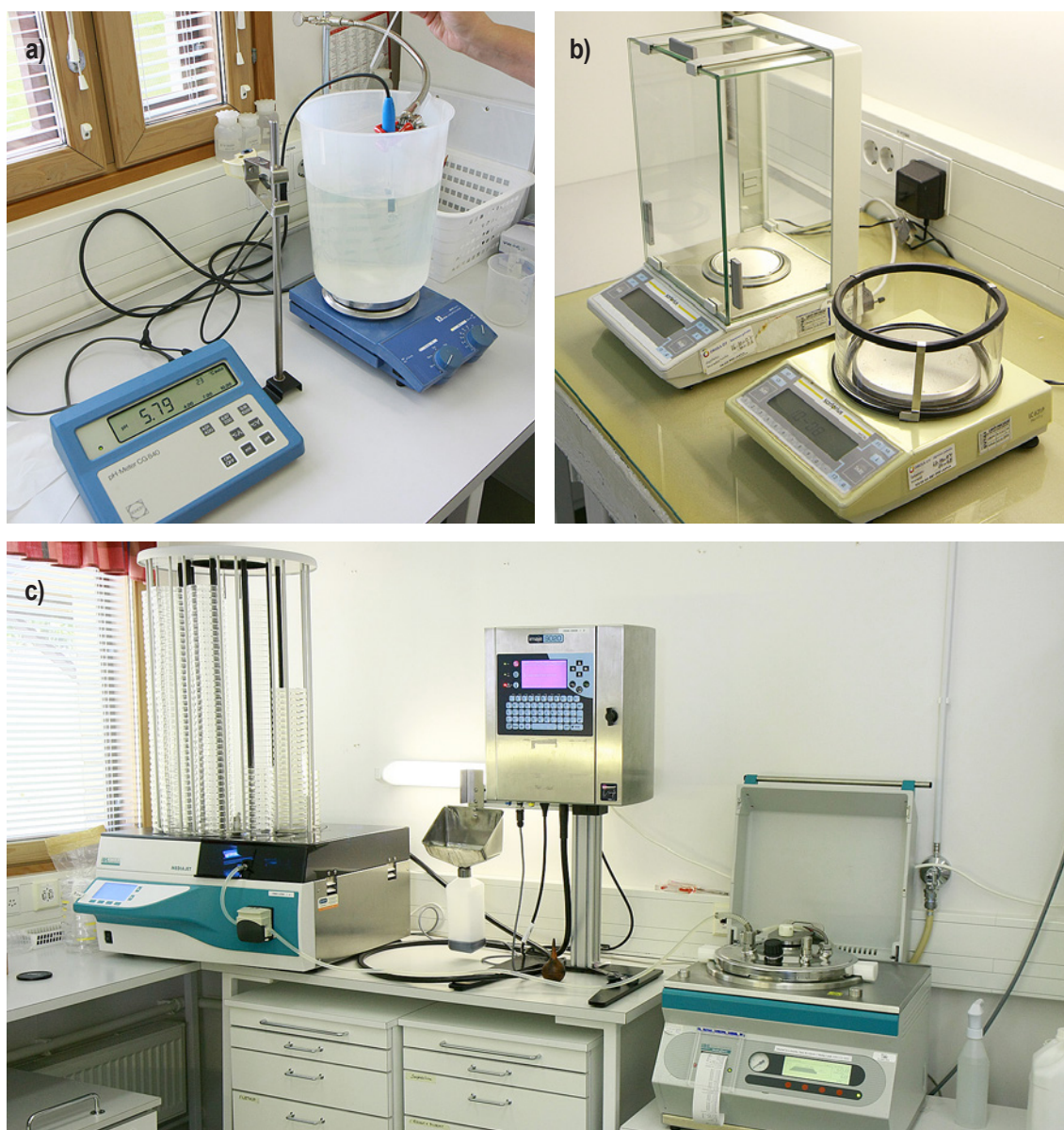
Kuva 4.7. a) Alustan pH mitataan ja säädetään tarvittaessa miedolla hapolla tai emäksellä. b) Vaako- ja kiinteiden aineiden punnitsemiseen. c) Automaattinen alustanvalmistuslaitteisto: oikealla alustaliemen autoklaavi eli sterilointilaitte, keskellä printteri jolla saadaan teksti maljan kylkeen ja vasemmalla maljojen täyttöyksikkö. Kuvat Lassi Palmujoki.
