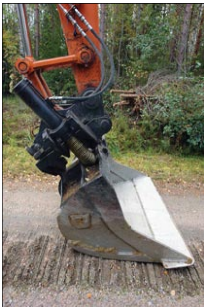
Рис. 13. На экскаваторе установлен планировочный ковш
