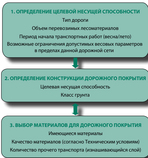
Рис. 7. Поэтапное проектирование дорожного покрытия
