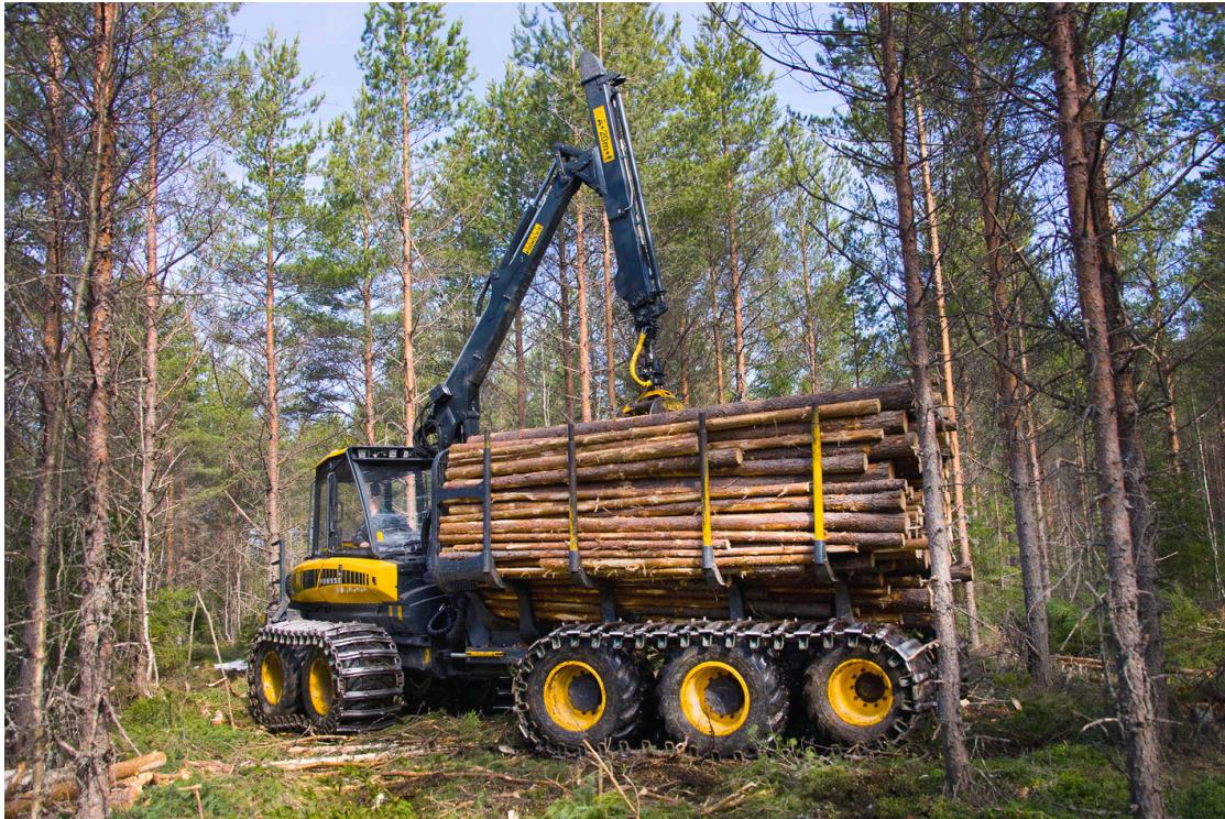
Kuva 22. Ponsse 10W – kymmenpyöräinen kuormatraktori on yksi ratkaisu pehmeiden maiden puunkorjuuseen. Kuva Ponsse Oyj.
