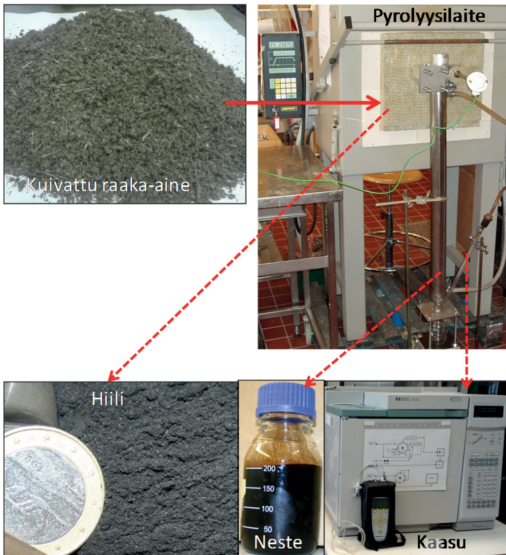
Kuva 1. Pyrolysoitava raaka-aine, laboratoriomittakaavan pyrolyysilaitte sekä pyrolyysissä syntyvät hiili-, neste- ja kaasujakeet.
