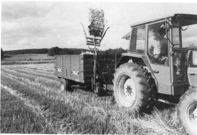
Kovapaalit kerätään usein käsin, mutta apuvälineitäkin on olemassa. Viska-paalinheitin oli koetuksessa ja sen todettiin helpottavan tuntuvasti raskasta paalien keruutyötä.
