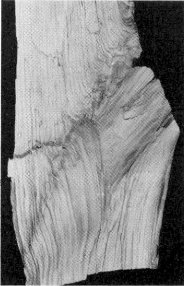
Männyn oksan liittyminen runkoon. Liitoksessa rungon puusyyt asettuvat vinoon, mikä alentaa oksaisen puun lujuutta. Lisäksi oksa on puun epä-jatkuvuuskohta, jossa runkopuun rakenne katkeaa.
