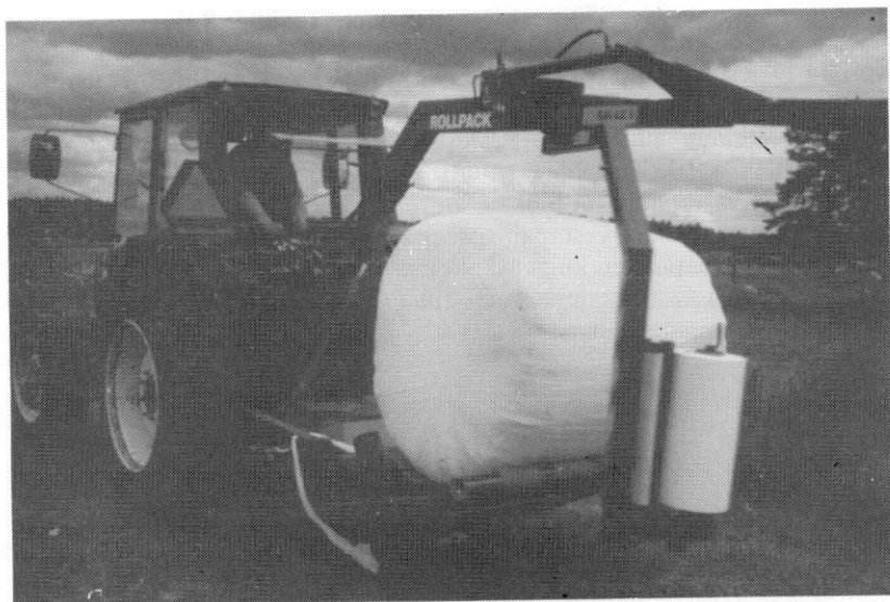
Kiedonta kiristemuoviin on varmempi paalien säilöntätapa kuin säkitys.
