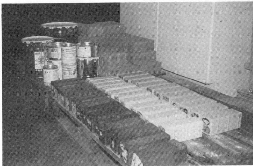
Eri pinnoitteilla käsiteltyjä betonikiviä laboratorikokeita varten.
