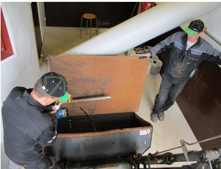
Kuva 13. Käsittelyjäännöksen poistoa reaktorin alaventtiilistä 12.6.2012.
