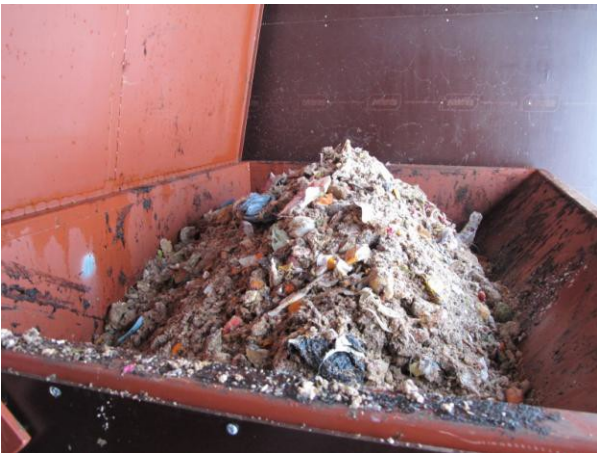
Kuva 2. Biojätetuorma kipattuna syöttösuppiloon. Kuva 3. Seula-alitemateriaali.
