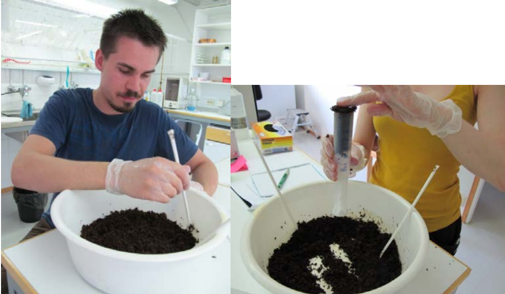
Kuva 5. Nitraattitypen määrittäminen. Mikko Hietaranta homogenisoi näytettä, josta Tiina Karppinen ottaa 40 ml puristeen.
