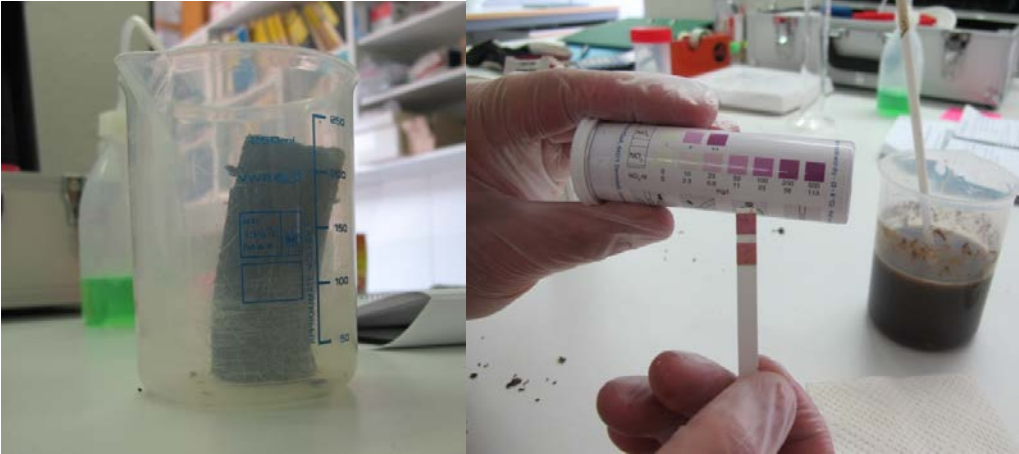
Kuva 6. Fennopol-jauheen ja uuttoliuoksen lisäämisen jälkeen näytettä saostetaan ja kirkastuneeseen pintaosaan kastetaan nitraatin ilmaisindiikka, jonka tulos tarkastellaan värivertailulla.
