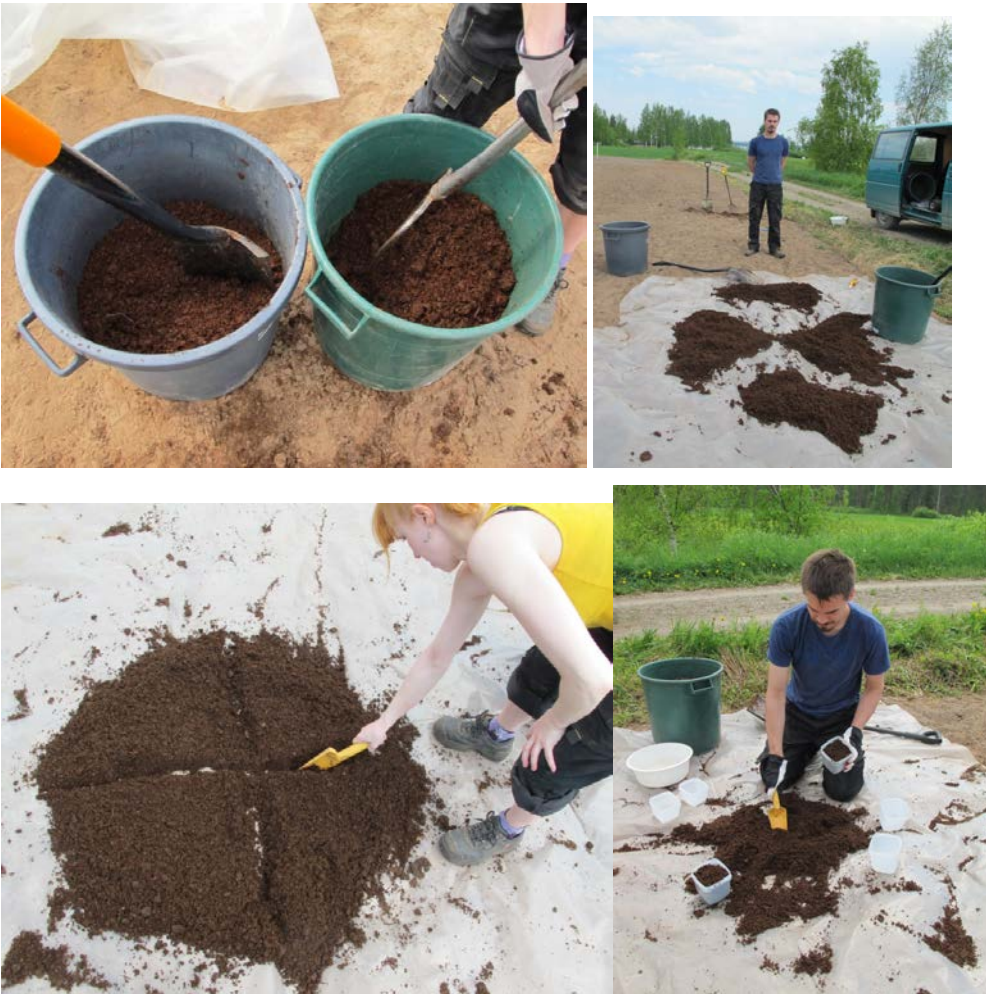
Kuva 4. Mikko Hietaranta ja Tiina Karppinen homogenisoivat ja vähensivät näytettä sekä pakkasivat näytteen astioihin säilytystä ja myöhempää analysointia varten.
