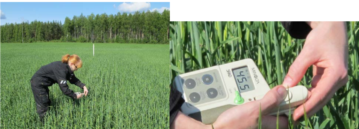
Kuva 16. Lehtivihreän mittaaminen Minolta Spad -klorofyllimittarilla.
