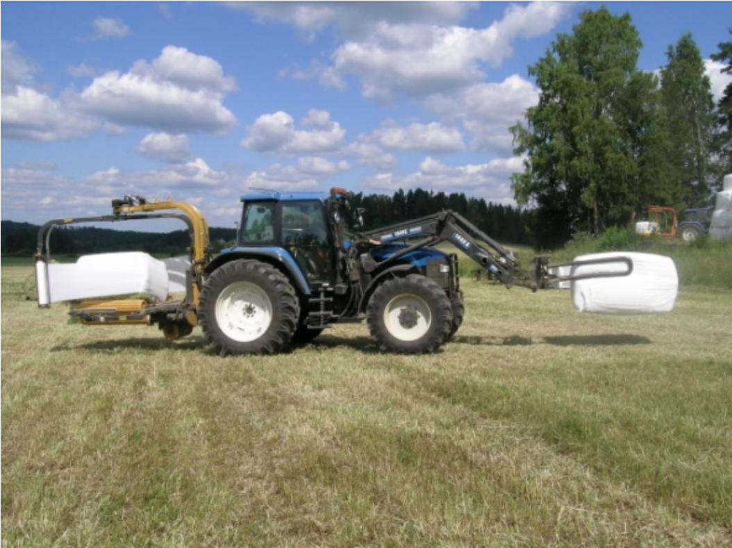
Kuva 29. Paalien keruu etukuormainpihdillä pellon reunalle samalla kun toista paalia kääritään takanostolaitekäärimestä.
