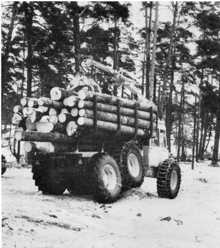
Kuormaa kantava metsätraktori, joka on varustettu hydraulisella kourakuormaimella.
