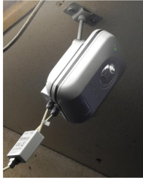
Kuva 26. TarckLab järjestelmää testataan MTT Maaningan CowLab TM :ssa. a) Lähetin kiinnitettynä lehmän RuminAct pantaan b) yksi neljästä vastaanottimesta navetan katossa. (Kuvat: Lilli Frondelius/MTT)
