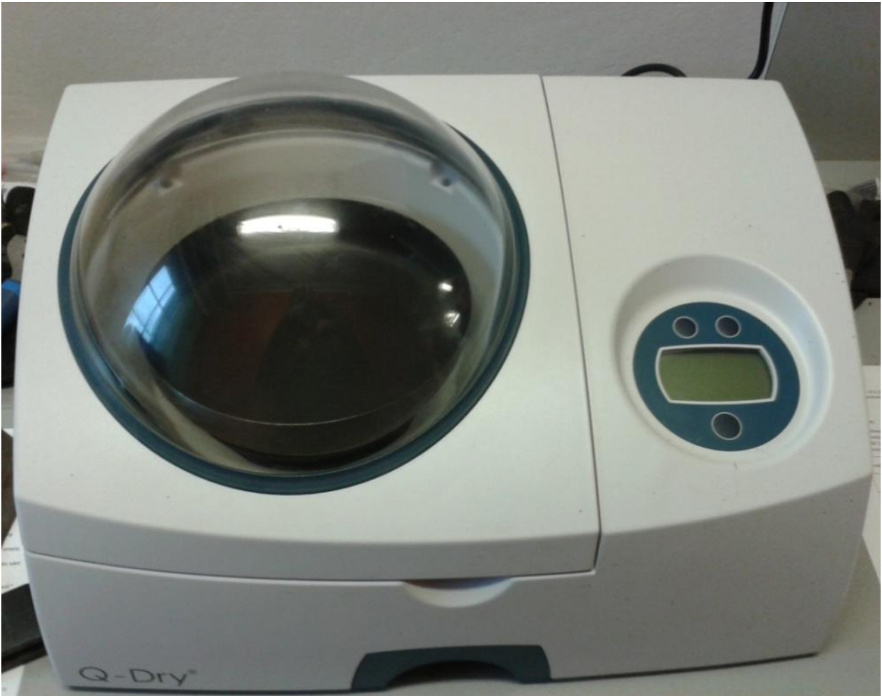
Kuva 11. Rehun kuiva-aineen pikamittari Q-dry. (Kuva: Sari Kajava/MTT)
