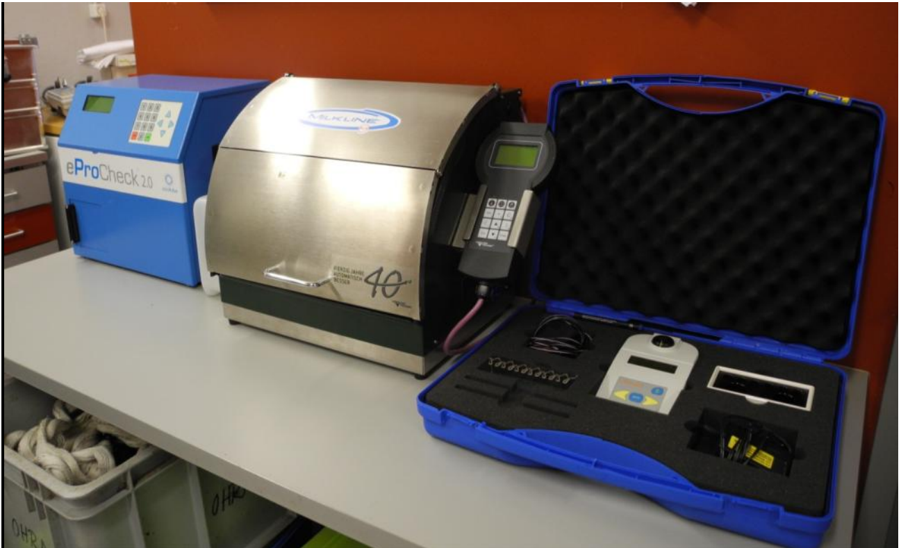
Kuva 5. Tilatason progesteronimittarit vasemmalta: eProCheck, HealthyLAB PG20 ja Hormonost Microlab Farmertest. (Kuva: Mikaela Mughal/MTT)
