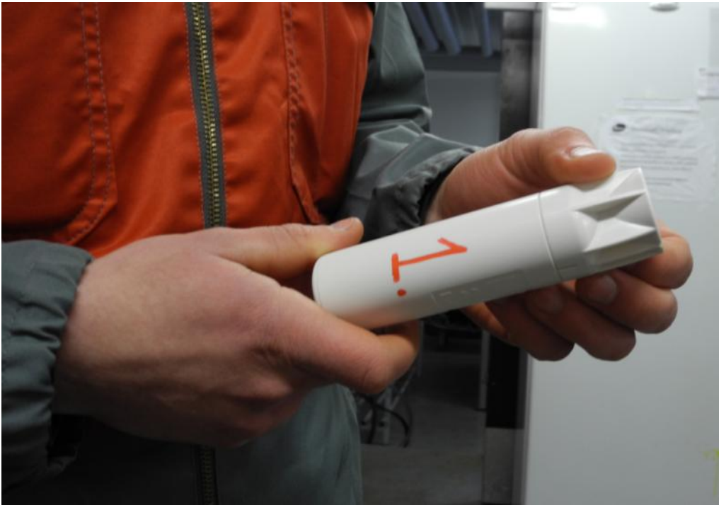
Kuva 23. smaXtec mittausanturi valmiina asennettavaksi suun kautta lehmän pötsiin (Kuva: MTT).
