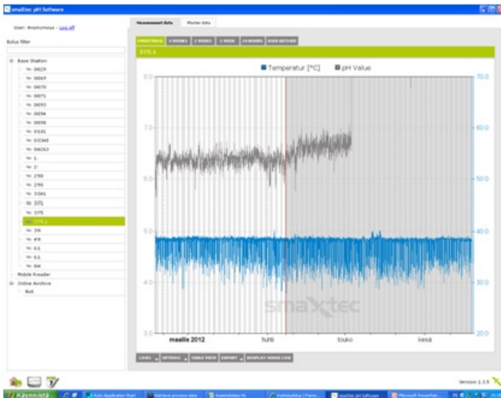
Kuva 24. Yhden smaXtec mittausanturin pH- (ylempi käyrä) ja lämpötilamittaukset (alempi käyrä) laitteiston käyttöliittymässä. pH-arvojen äkillinen nousu johtuu mittausanturin mittauspään kulumisesta tai likaantumisesta.
