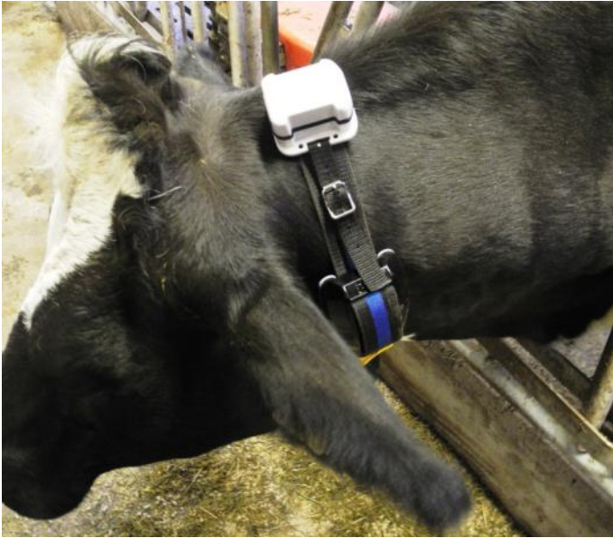
Kuva 26. TarckLab järjestelmää testataan MTT Maaningan CowLab TM :ssa. a) Lähetin kiinnitettynä lehmän RuminAct pantaan b) yksi neljästä vastaanottimesta navetan katossa. (Kuvat: Lilli Frondelius/MTT)
