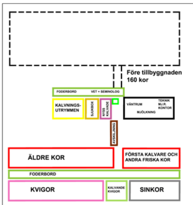
Bild 14. Mjölkningsstationen kan också inrymmas i en byggnad som är avskild från huvudhallen med en tvärgång, och som innehåller utrymmen för kalvande kor och kor som ska observeras. En sådan placering gör det möjligt att vid utvidgning av besättningen placera en andra (och tredje) djurhall på mjölkningsstationens motsatta sida. Det finns mjölkningsstationer av flera olika modeller.
