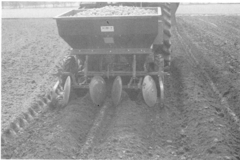
Kuva 2. Automaattinen Underhaug 1400 perunanistutuskone Figure 2. Automatic Underhaug 1400 potato planter
