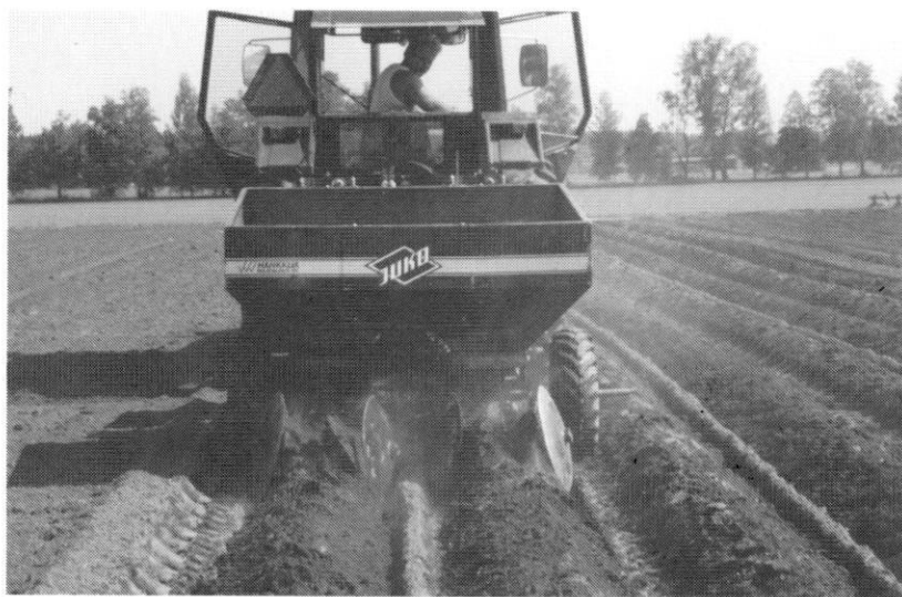
Kuva 1. Automaattinen Juko 242 S perunanistutuskone Figure 1. Automatic Juko 242 S potato planter
